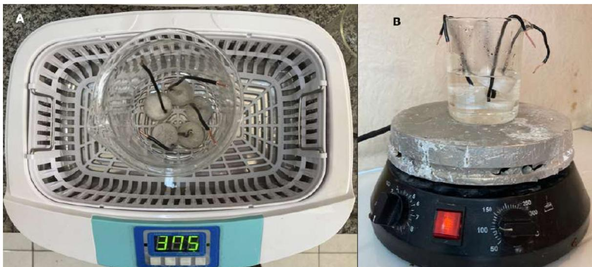
Figura 11 – A) Lavagem das amostras na cuba ultrassônica; B) Tratamento das superfícies através da imersão em solução de ácidos sulfúrico, clorídrico e água destilada à 80°C.
