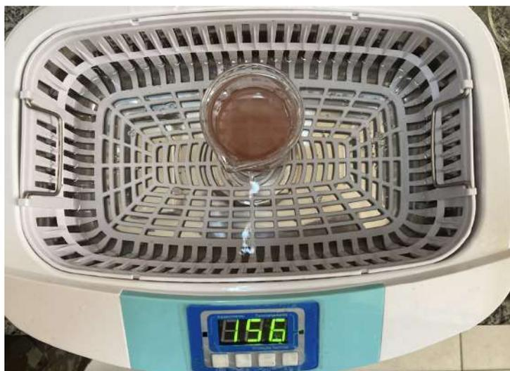
Figura 12 – Sonicação da solução aquosa contendo 0,5 mg/ml de  $\text{Cu}_2\text{OSMPs}$ .
