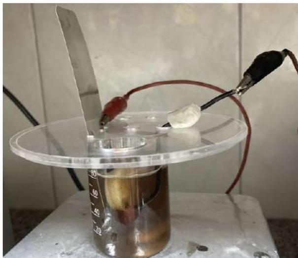
Figura 14 – Eletrodeposição de GO na amostra de Ti.
