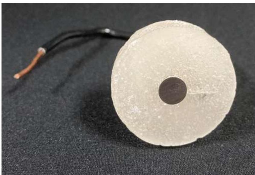
Figura 10 – Amostra de Ti grau 5 soldada no fio rígido de Cu e embutida em resina acrílica.
