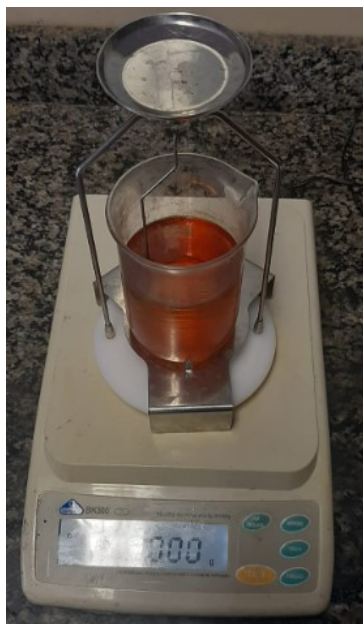
Figura 3.7 – Balança hidrostática utilizada para a determinação da densidade pelo princípio de Arquimedes.
