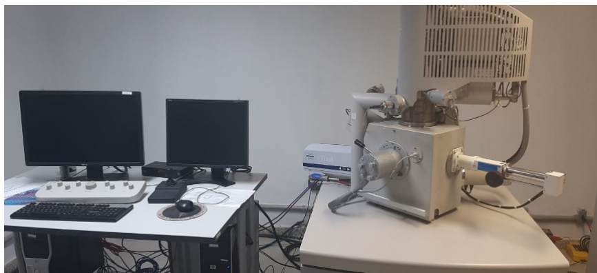
Figura 3.15 – Equipamento MEV FEG 250 do IME.
