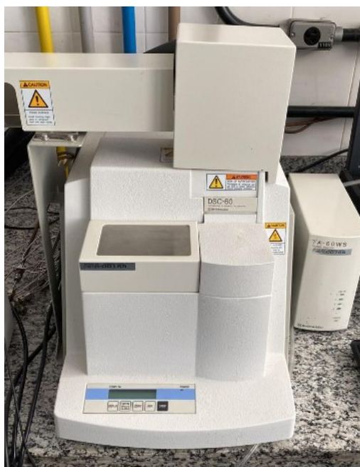
Figura 3.17 – Equipamento Shimadzu modelo DSC 60.
