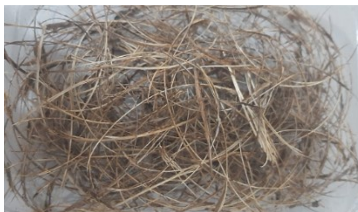
Figura 3.5 – Fibra de babaçu após desfibrilamento.
