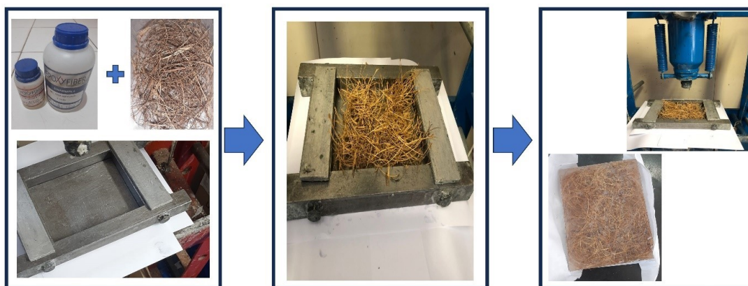
Figura 3.10 – Representação da fabricação da placa de matriz de fibra de babaçu.
