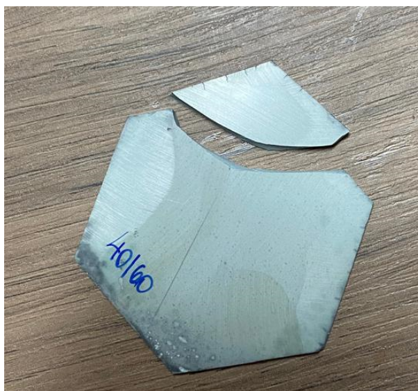
Figura 33 – Amostra S40-4 fissurada após ensaio de dureza Rockwell A.
