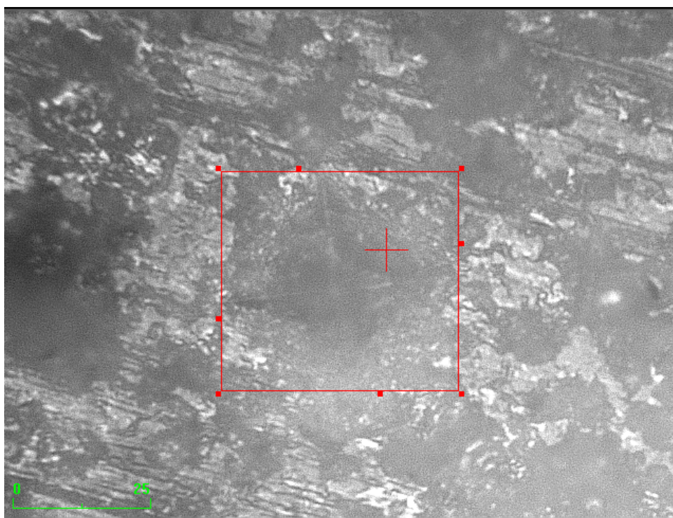
Figura 32 – Indentação HV 1,0 na amostra S40-4.
