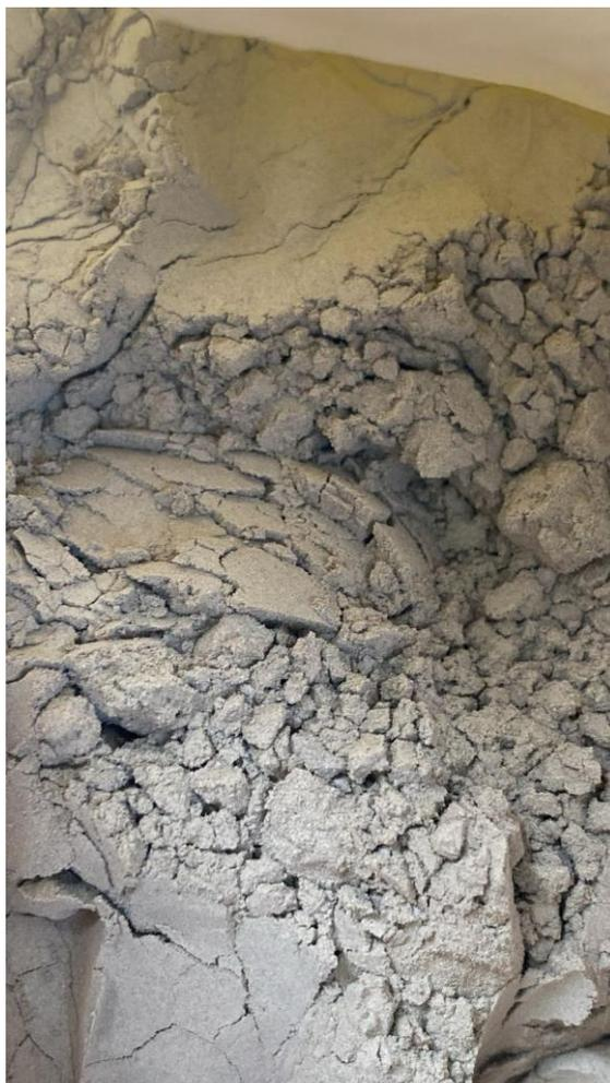
Figura 14 – Cinzas Volantes da usina da ENGIE em Pampa.
