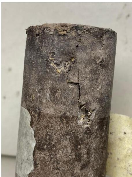
Figura 55 – Fratura da pasta geopolimérica com 4% de fibra de sisal após 21 dias de cura.
