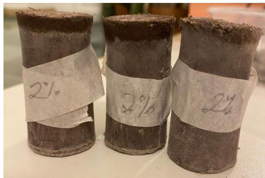
Figura 17 – Corpos de prova 2% de fibra de sisal.
