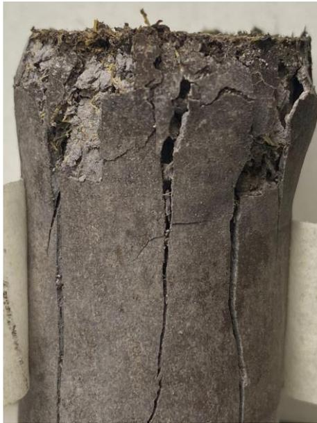
Figura 49 – Fratura da pasta geopolimérica com 4% de fibra de sisal após 7 dias de cura.
