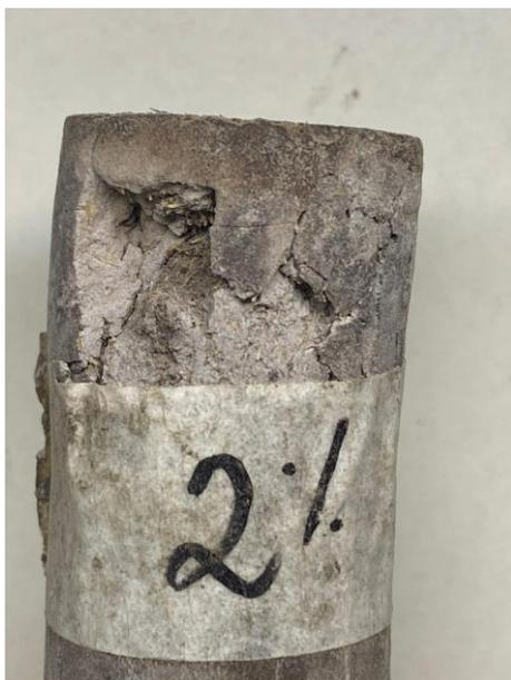
Figura 54 – Fratura da pasta geopolimérica com 2% de fibra de sisal após 21 dias de cura.
