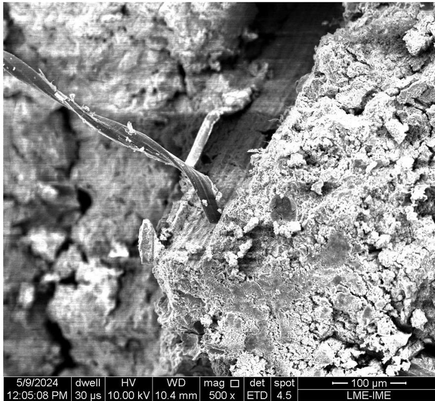
Figura 41 – Microscopia Eletrônica de Varredura Pasta Geopolimérica com 4% de Fibra de Sisal. Aumento de 500x.
