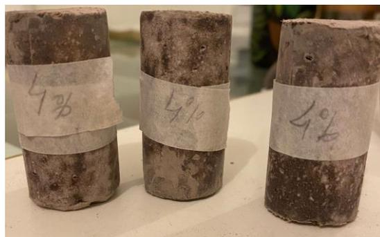
Figura 18 – Corpos de prova 4% de fibra de sisal.
