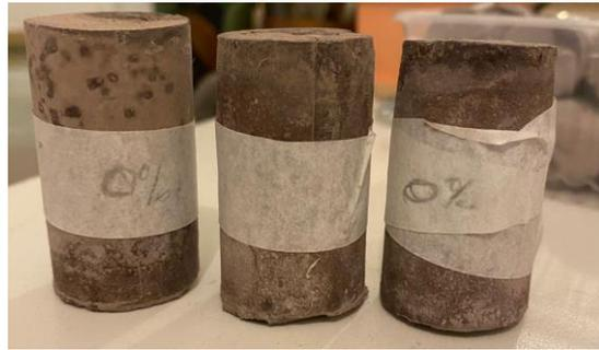
Figura 16 – Corpos de prova 0% de fibra de sisal.
