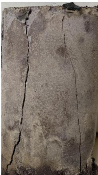
Figura 52 – Fratura da pasta geopolimérica com 4% de fibra de sisal após 14 dias de cura.
