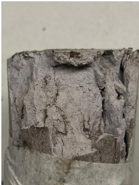
Figura 50 – Fratura da Pasta Geopolimérica após 14 dias de cura.
