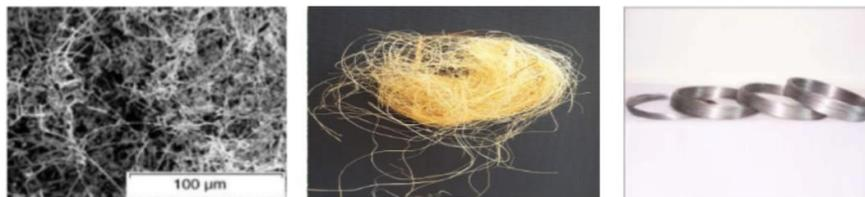
Figura 12 – A primeira é whiskers  $\text{Al}_2\text{O}_3$ , a segunda são fibras de sisal e por último arame (8)
