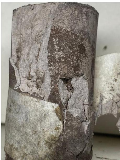
Figura 53 – Fratura da pasta geopolimérica após 21 dias de cura.
