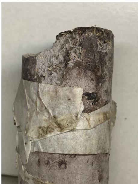
Figura 51 – Fratura da pasta geopolimérica com 2% de fibra de sisal após 14 dias de cura.
