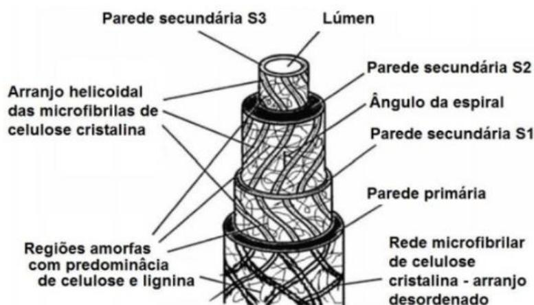
Figura 6 – Arranjo microestrutural da FNL's (5).
