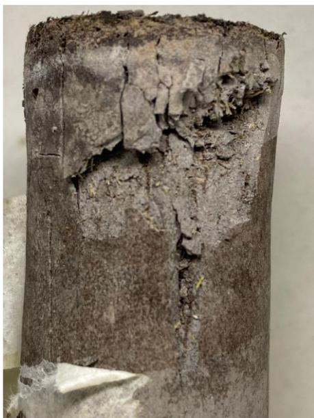
Figura 48 – Fratura da pasta geopolimérica com 2% de fibra de sisal após 7 dias de cura.
