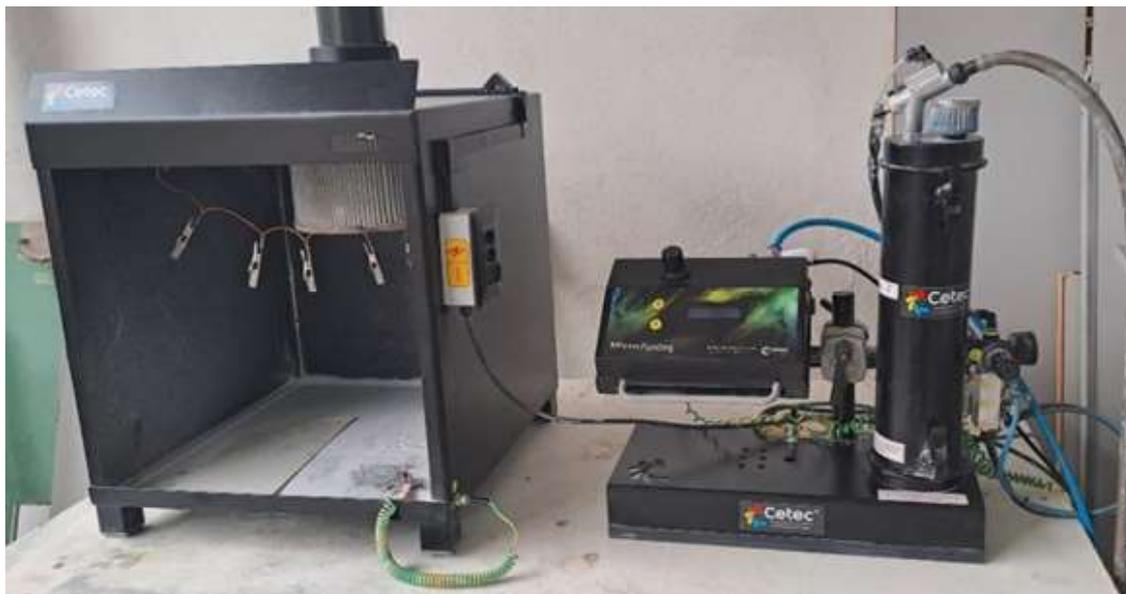
Figura 12 – Equipamento Tecnoplus (Cetec Equipamentos para Pintura, Barueri, SP, Brasil) usado na pintura eletrostática. Fonte: Autor.
