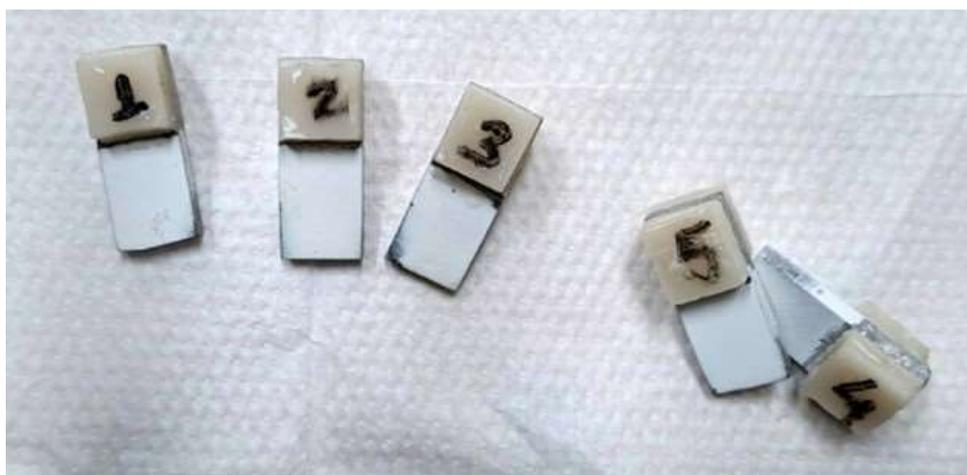
Figura 14 – Corpos de prova de NiCr pintado cimentado a resina. Fonte: Autor.
