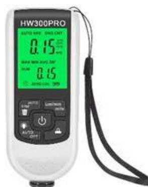
Figura 13 – Equipamento usado para medir a espessura da tinta. Fonte: Empresa Hitech.
