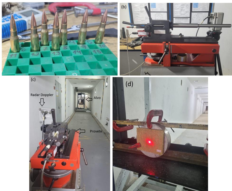
Figura 47 – Equipamentos utilizados no ensaio de velocidade residual: (a) Munições 7,62 mm; (b) Provete; (c) *Setup* montado; (d) Alvo (compósito híbrido) posicionado com a mira a laser
