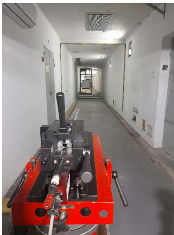
Figura 25 – Túnel balístico da Seção de Testes do CAEx. Em destaque, o provete e, ao fundo, o alvo.
