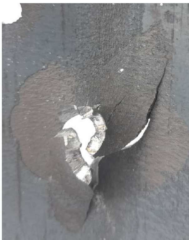
Figura 51 – CP 540_2: Face posterior da placa inferior de aço maraging relativa ao impacto número 3.
