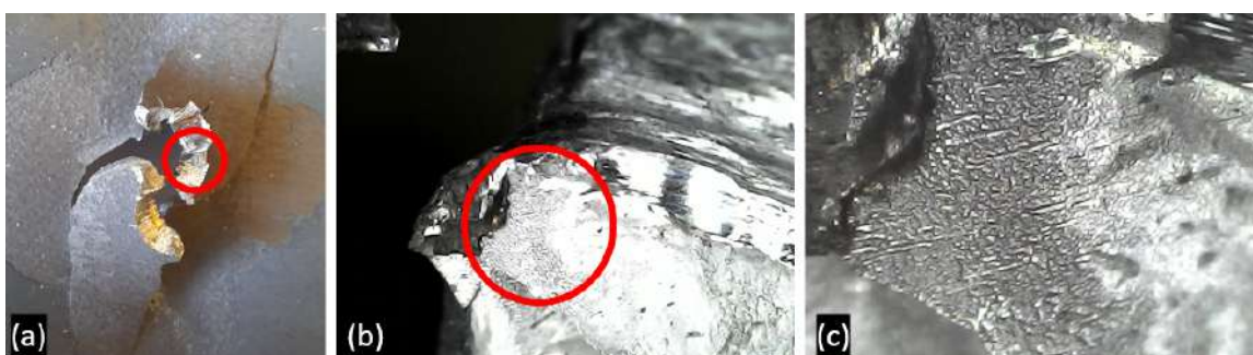
Figura 62 – Aspecto macrográfico (a) e detalhes micrográficos (b,c) da superfície de fratura do impacto balístico número 5 que atingiu a placa envelhecida a 540 °C por 3 h.
