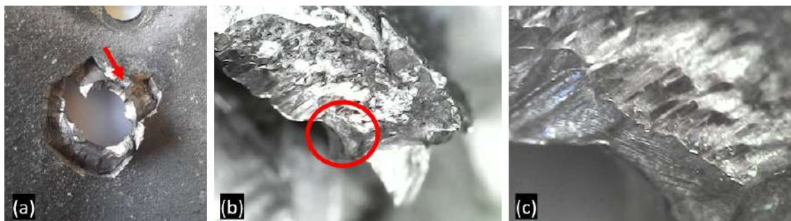
Figura 61 – Aspecto macrográfico (a) e detalhes micrográficos (b,c) da superfície de fratura do impacto balístico número 5 que atingiu a placa envelhecida a 480 °C por 5 h.
