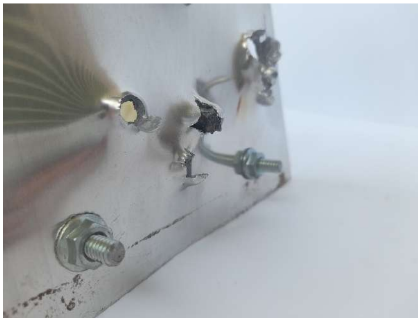
Figura 47 – Fragmento da placa de aço maraging retido na placa de alumínio no terceiro impacto do CP 450_1.
