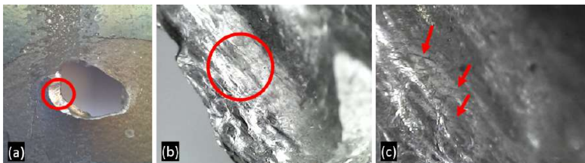
Figura 60 – Aspecto macrográfico (a) e detalhes micrográficos (b,c) da superfície de fratura do impacto balístico número 3 que atingiu a placa envelhecida a 450 °C por 3 h.
