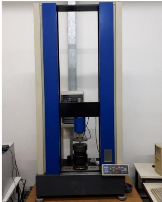
FIG. 3.4 Máquina de Ensaio EMIC utilizada para compactação da mistura de pós.
