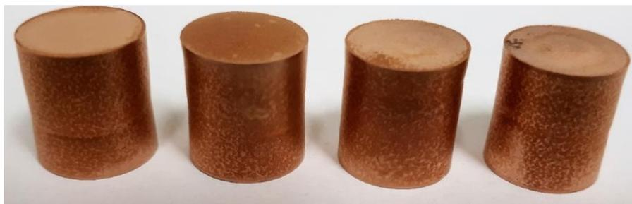
FIG. 4.19 Amostras compactadas a 686 MPa e sinterizadas a 950 °C por 2 h com alteração das dimensões e do formato cilíndrico.
