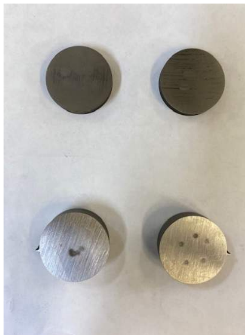
Figura 3.7 – Amostras “sacrifício” para proteção do sistema de barras
