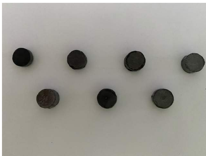
Figura 3.5 – Ilustração real dos corpos de prova obtidos pela técnica SPS
