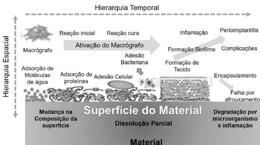
Figura 7 – Esquema das reações que ocorrem na superfície do implante de titânio. Adaptado de (10)
