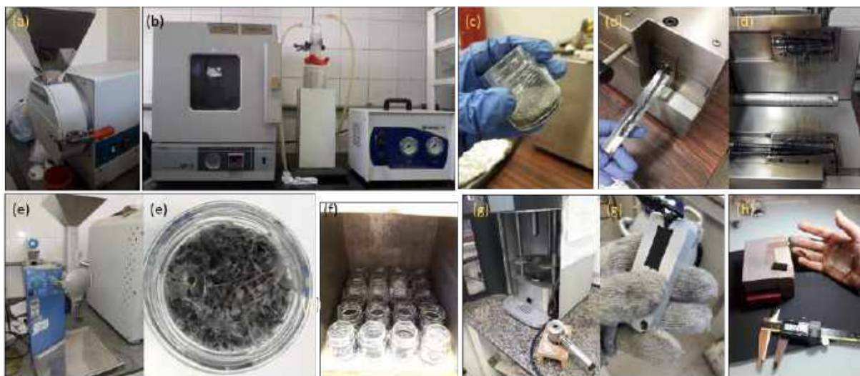
Figura 21 – Etapas de fabricação dos compósitos. (a) Moagem do pellet. (b) Secagem do pellet/GNP. (c) Pré-mistura. (d) Extrusão. (e) Moagem dos compósitos extrudados (f) Secagem dos compósitos moídos. (g) Injeção do corpo de prova na dimensão final. (h) Ajuste dimensional do corpo de prova.
