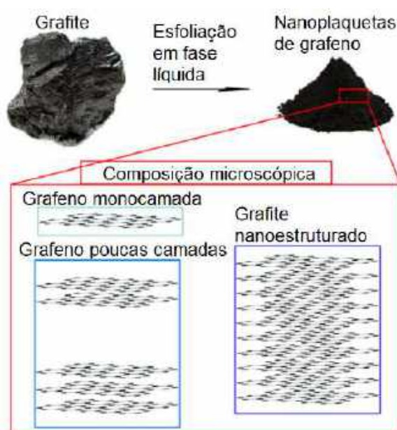
Figura 8 – Esquema de uma rota de produção de GNPs partindo do grafite (adaptada de (21)).
