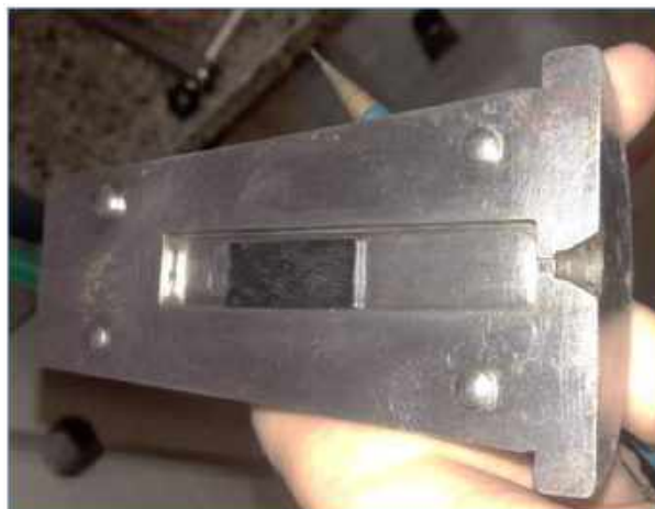
Figura 79 – Molde 0, fornecido por fabricante de equipamento, já disponível no laboratório. Cavidade com aproximadamente 12,5 x 62,5 x 3,3 mm.
