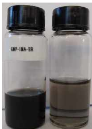
Figura 110 – Fotografia digital da dispersão em solvente orgânico da amostra Cheap Tubes G3. (a) dispersão mãe produzida por ultrassonificação por 60 min em solvente orgânico e concentração inicial de sólido de 0,1 g /L; (b) Dispersão diluída 10 vezes a partir da dispersão mãe.
