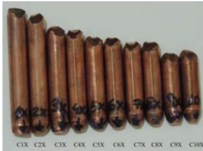
FIG. 3.4: Amostras obtidas após cada passe pelo ECAP.
