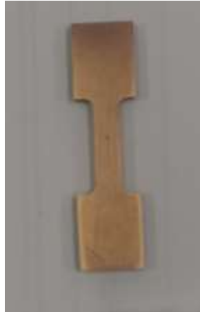
FIG. 3.12: Corpo-de-prova para o ensaio de tração.
