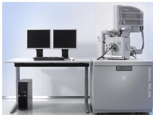
FIG 3.14: Microscópio Eletrônico de Varredura com Fonte de Emissão de Campo QUANTA FEG 250 (FEI, 2016).
