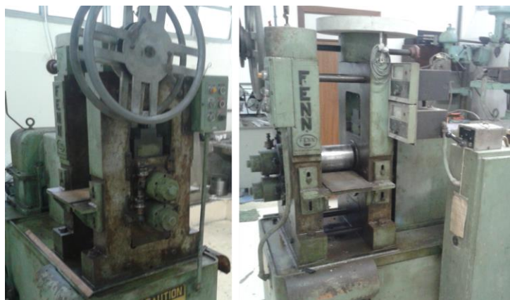
FIG. 3.3 Laminador instalado no Laboratório de Processamento Termomecânico do IME.
