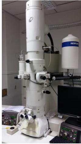
FIG. 3.7 Microscópio Eletrônico de Transmissão instalado no IME.
