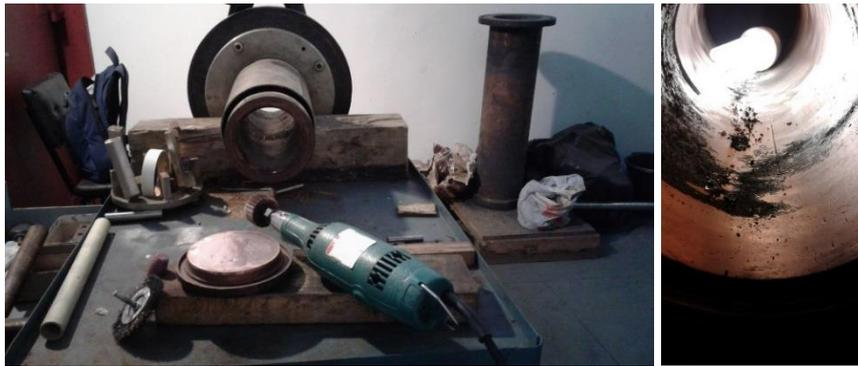
Figura 3-18: Limpeza dos cadinhos de cobre utilizados no processo de fusão em VAR (AUTOR).
