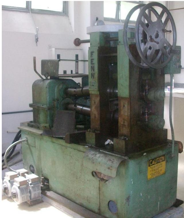
Figura 3-25: Laminador FENN MFG Co., modelo D-51710 : 1973. Laboratório de Processamento Mecânico, IME (AUTOR).
