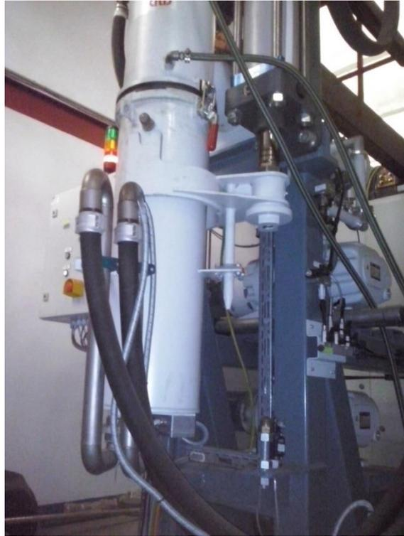
Figura 3-17: Forno de refusão a vácuo (VAR) da ALD, modelo VAR L200 Ti Zr, COPPE/UFRJ (AUTOR).
