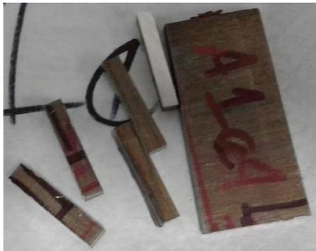
Figura 3-39: Retalhos de amostra para ensaio de picnometria (AUTOR).
