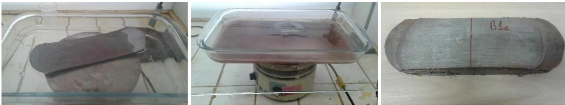
Figura 3-29: A decapagem é realizada para remover a cama de óxido da superfície do material. O processo é um ataque ácido, que pode ser aquecido para intensificar o ataque (AUTOR).
