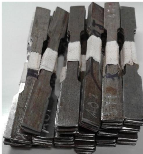
Figura 3-41: Corpos de prova para ensaio de tração usinados por fresa em CNC (AUTOR).
