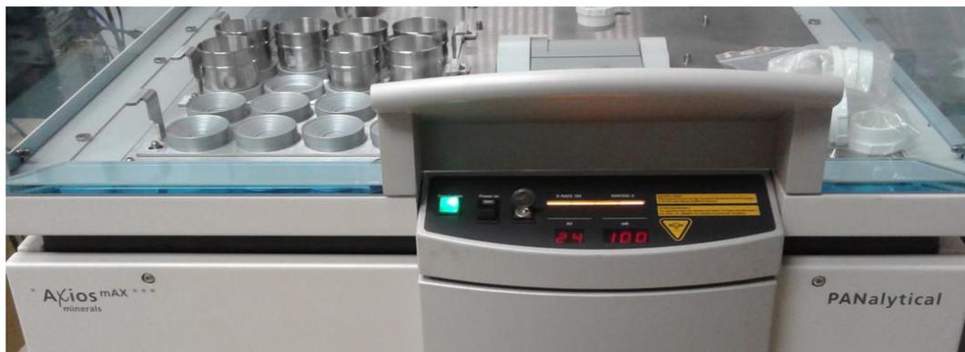
Figura 3-45: PANalytical Axios<sup>mAX</sup> minerals, presente no CPRM, equipamento para análise química por fluorescência de raios-X (AUTOR).
