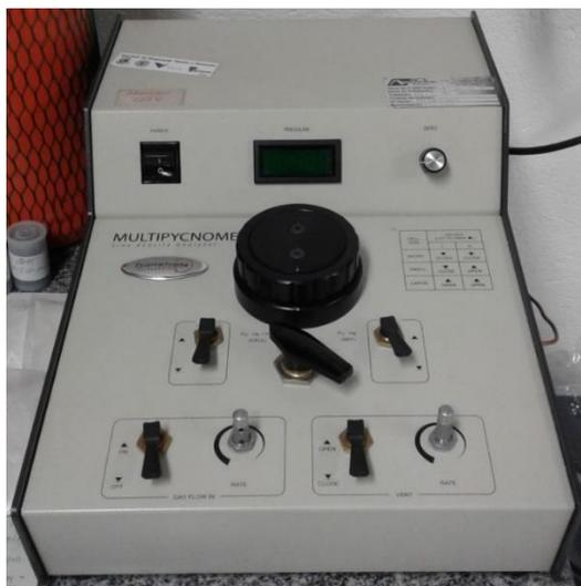
Figura 3-47: Multipicnômetro da Quantachrome, Unifei *campus* Itabira/MG (AUTOR).
