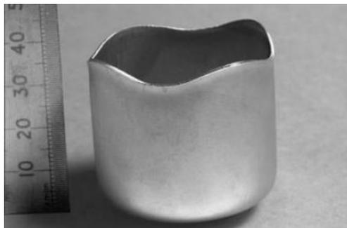
Figura 3-57: Orelhamento após conformação de amostra metálica (HOILE, 2000).
