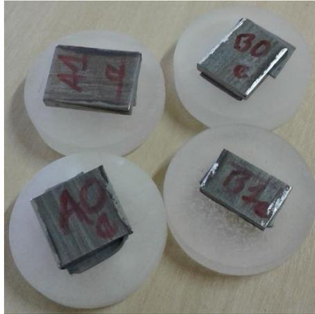
Figura 3-38: Amostras coladas na resina de embutimento para preparação metalográfica (AUTOR).
