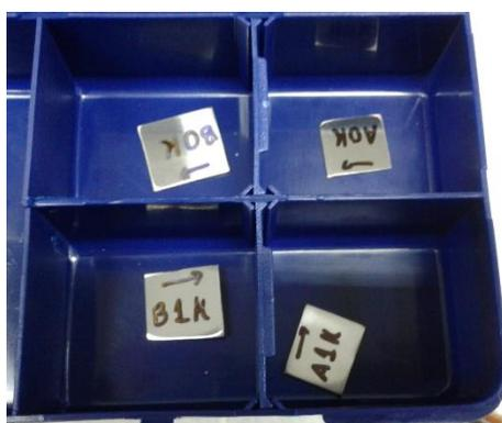
Figura 3-37: Amostras para MEV tratadas com Nital 5% durante 15 segundos (AUTOR).
