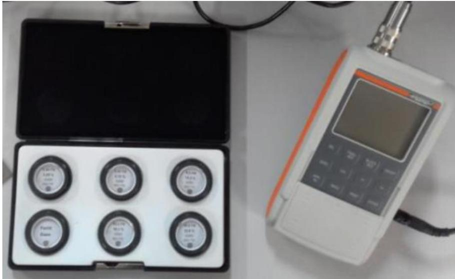
Figura 3-61: Ferritoscópio para quantificação de martensita e padrões de ferrita (ALVES, 2018).
