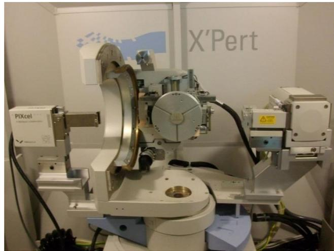
Figura 3-48: PANalytical X'Pert PRO MRD do Laboratório de Difração de raios-X, IME (AUTOR).
