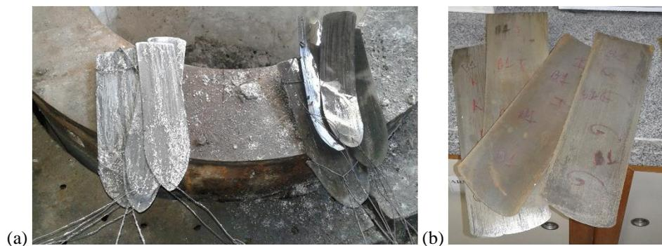
Figura 3-34: (a) Amostras tratadas termicamente e (b) decapadas (AUTOR).
