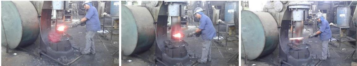
Figura 3-22: Processo de forjamento na empresa ForjaRio, Rio de Janeiro, demonstrando o prolongamento da chapa como consequência da deformação mecânica (AUTOR).
