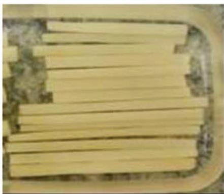
Figura 1 - Corpos de prova com forma de paralelepípedo para ensaio de flexão em solução para manter a hidratação.
