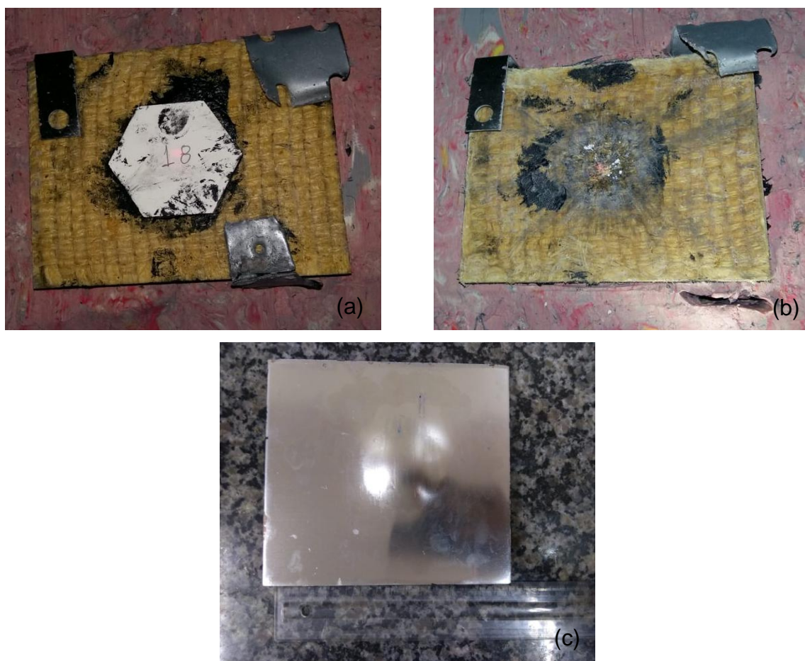
FIG. 4.32 Blindagem multicamada com 40% de tecido de fique: (a) antes e (b) após o impacto balístico, e (c) não perfuração da placa de alumínio.
