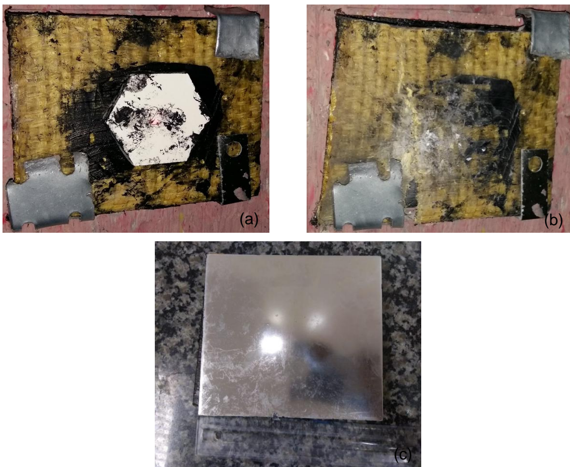
FIG. 4.28 Blindagem multicamada com 15% de tecido de fique: (a) antes e (b) após o impacto balístico, e (c) não perfuração da placa de alumínio.
