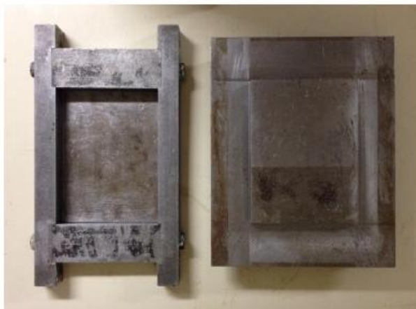
FIG. 3.12 Molde metálico utilizado na fabricação dos compósitos.
