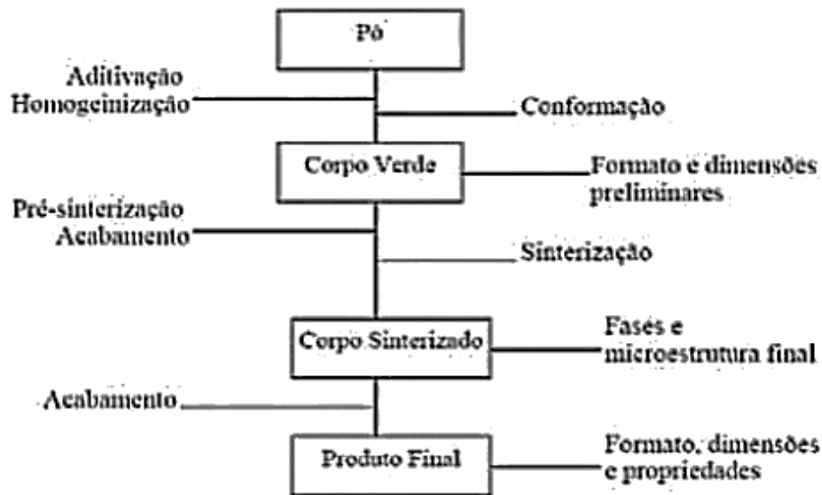
FIG. 2.6 Etapas básicas do processamento cerâmico.
