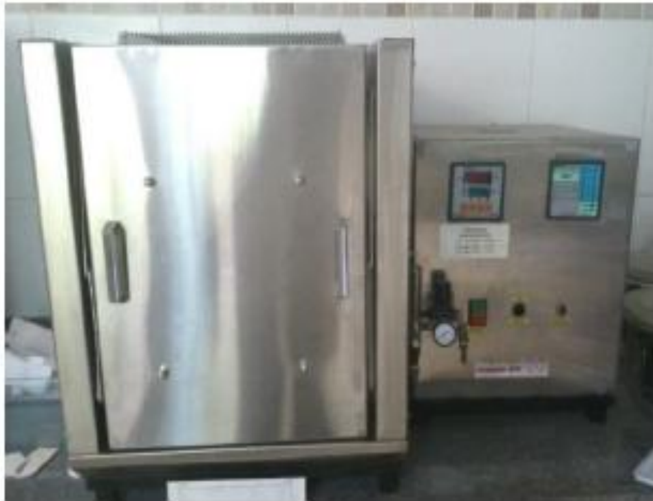
FIG. 3.8 Forno INTI FE 1700 utilizado na sinterização das pastilhas cerâmicas.
