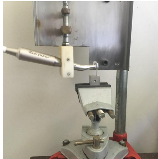
FIG. 4.2 Dispositivo utilizado nos ensaios de flexão rotativa.
