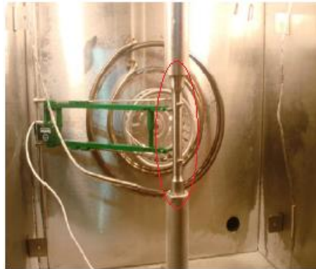
FIG 2.24: Imagem da câmara criogênica com o CP (YOO, S.W. et al. , 2011).
