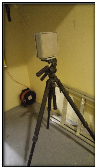
FIG. 3.12 Radar Doppler Weibel SL-520P utilizado no ensaio de velocidade residual.
