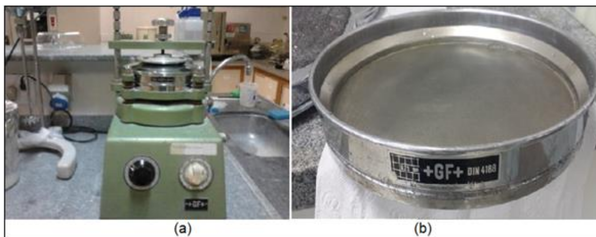
FIG. 3.5 Equipamento da +GF+ para peneirar pós, composto por: (a) agitador TWB; (b) peneira DIN 4188, com abertura de 0,250 mm.
