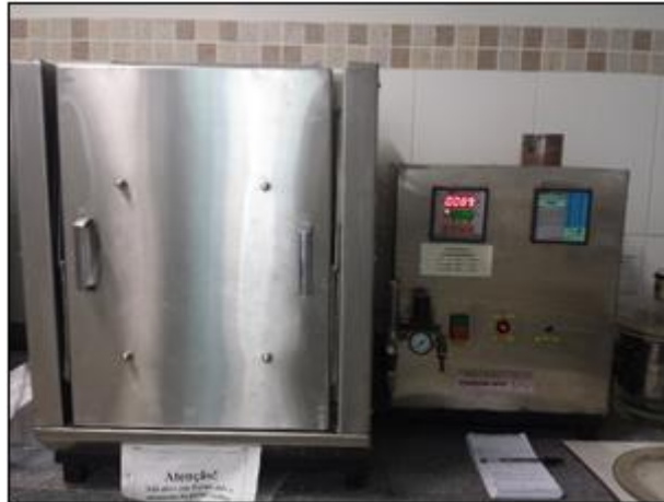
FIG. 3.8 Forno FE-1700 da marca INTI utilizado na sinterização.
