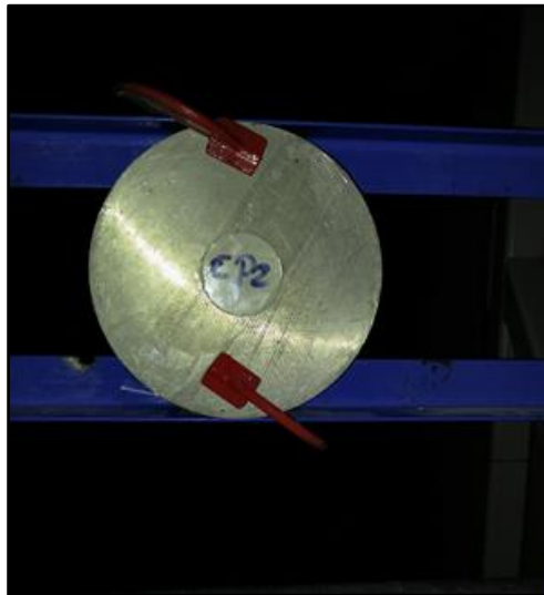
FIG. 3.13 Fixação dos alvos cerâmicos para o ensaio de velocidade residual.
