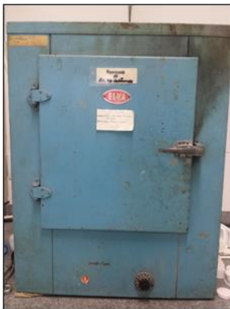
FIG. 3.4 Estufa Elka utilizada para a secagem do pó.
