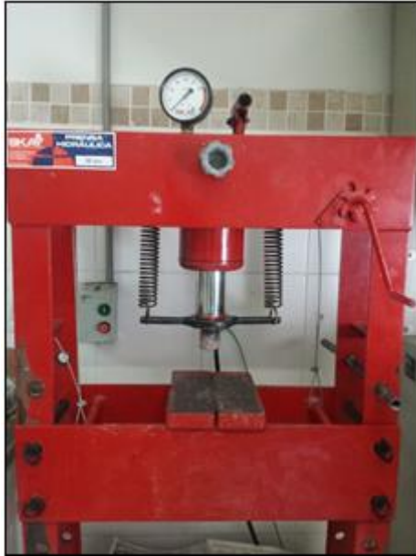
FIG. 3.7 Prensa hidráulica da marca SKAY com capacidade de 30 ton.
