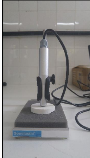
FIG. 3.10 Equipamento da Sonelastic® para medição de propriedades elásticas.
