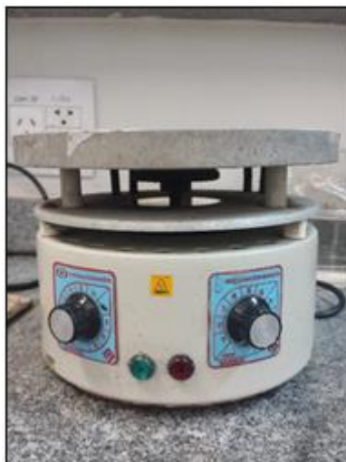
FIG. 3.2 Agitador magnético com aquecimento Q261, da marca Quimis
