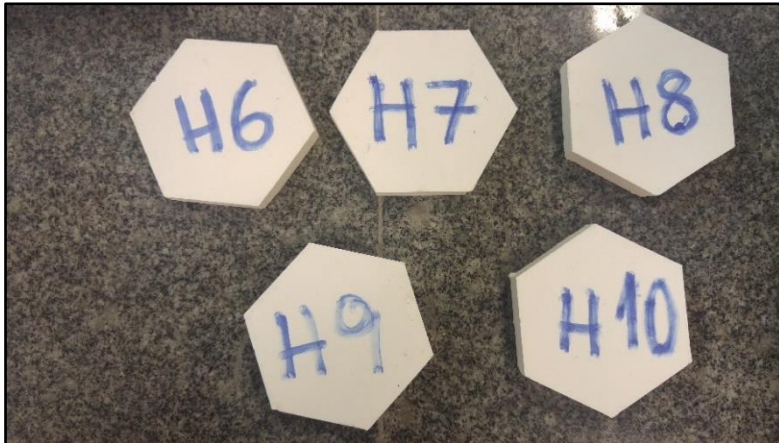
FIG. 3.14 Corpos de prova cerâmicos hexagonais utilizados no ensaio de na plastilina.
