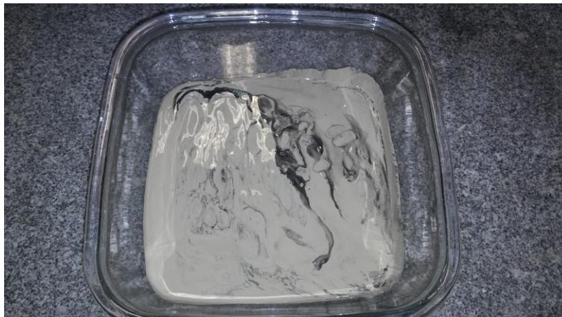
FIG. 3.8 Acondicionamento da mistura para secagem
