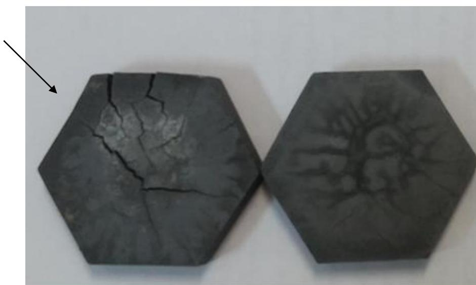
FIG. 4.20 Corpo de prova hexagonal com defeito
