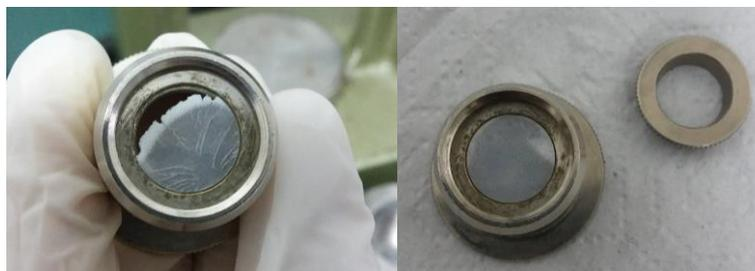
FIG. 3.6 Pastilha para análise de infravermelho
