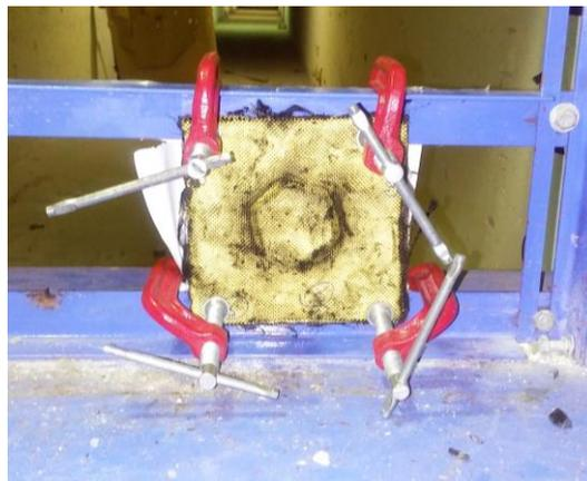
FIG. 3.20 Sistema para o ensaio de velocidade residual
