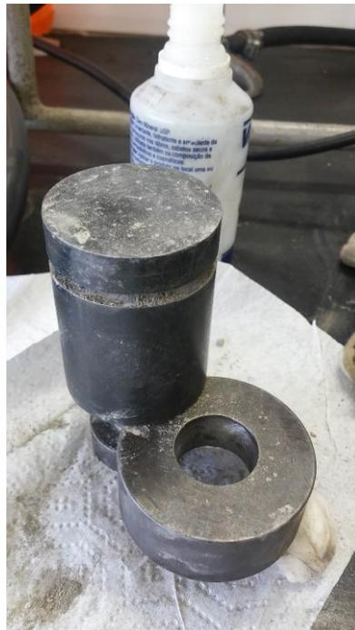
FIG. 3.9 Matriz para a prensagem dos corpos cilíndricos
