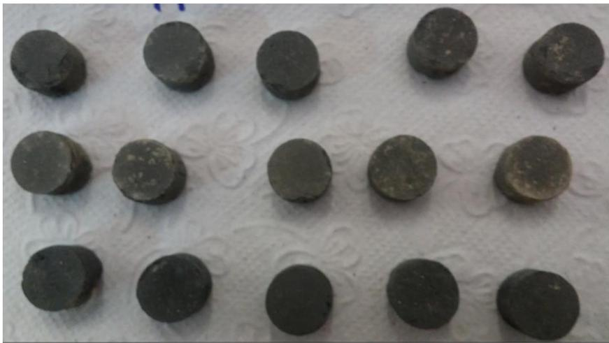
FIG. 4.17 Corpos de prova cilíndricos sinterizados à 1950°C
