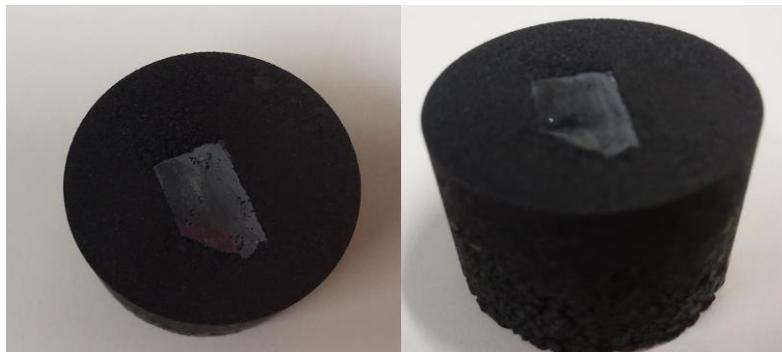
FIG. 3.13 Amostras embutidas em baquelite
