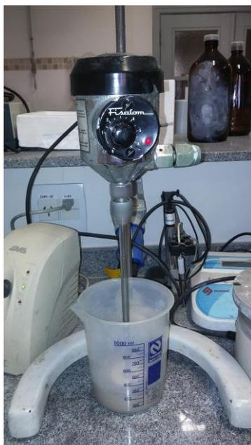
FIG. 3.7 Agitação da mistura no agitador FISATOM
