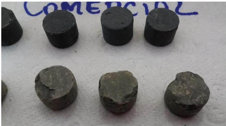
FIG. 4.18 Corpo de prova cilíndrico com defeitos
