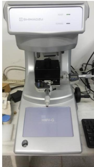
FIG. 3.16 Durômetro Shimadzu
