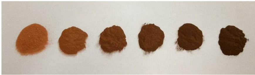
FIG. 3.12 Aspecto do pó de cobre puro em relação aos pós de compósitos com 0,2, 0,4, 0,6, 0,8 e 1,0% de GO, da esquerda para direita.
