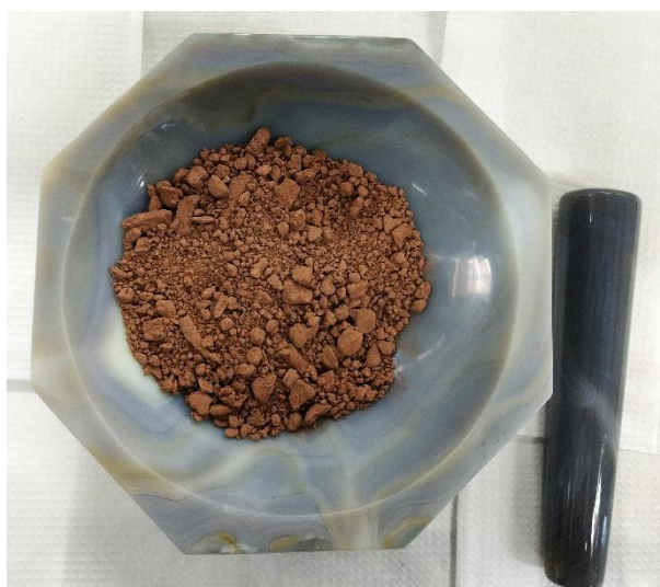
FIG. 3.11 Mistura de Cu-1,0%GO aglomerada.
