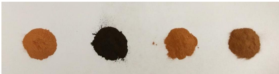
FIG. 3.8 Aspecto dos pós de Cu puro, Cu-0,4%GO seco a 60°C, Cu-0,1%GO e Cu-0,3%GO secos a vácuo, da esquerda para direita.
