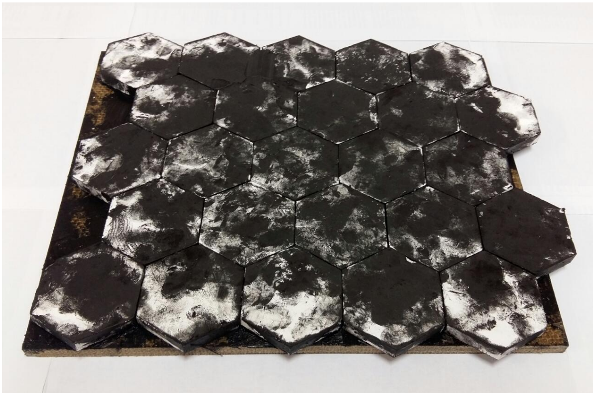
FIG. 3.18 Colagem das camadas do mosaico cerâmico e do compósito reforçado com tecido de juta.
