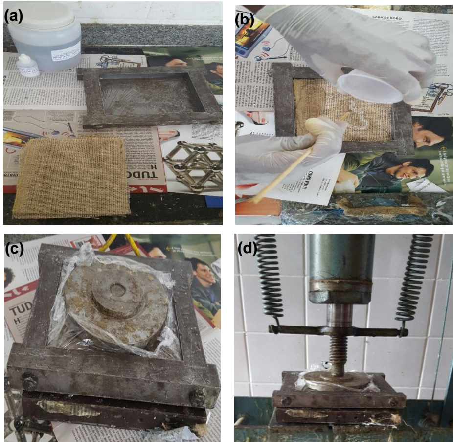
FIG. 3.7 Etapas da preparação do material compósito: (a) matriz metálica, tecido de juta, resina poliéster e catalisador; (b) as fibras dentro da matriz junto à resina poliéster ainda líquida; (c) matriz fechada; (d) prensagem da matriz metálica.
