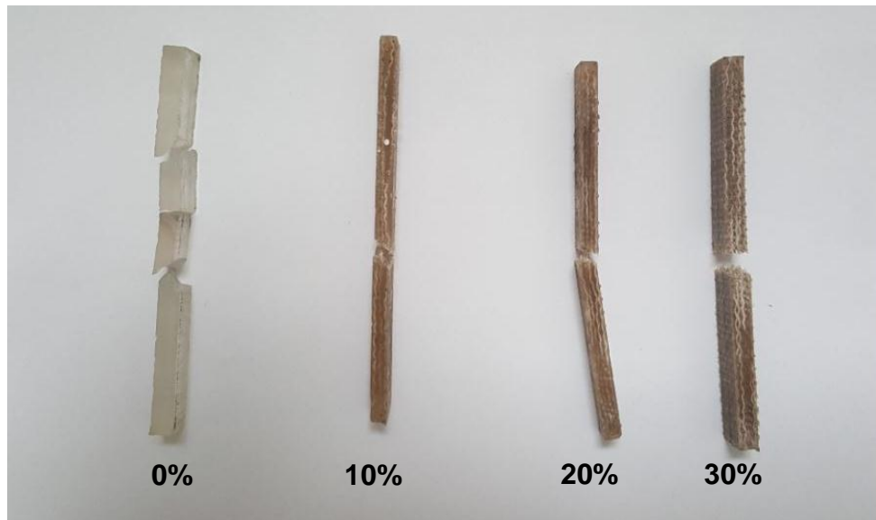
FIG. 4.11 Aspecto macroscópico dos corpos de prova de flexão rompidos dos compósitos poliéster-juta e poliéster puro.
