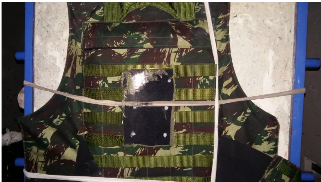
FIG. 4.16 Colete balístico após o primeiro disparo.
