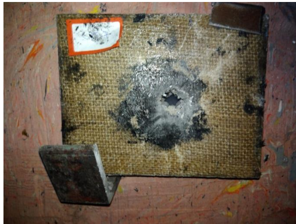
FIG. 4.18 Sistema de blindagem multicamada após o disparo da munição de calibre 7,62x51 mm.
