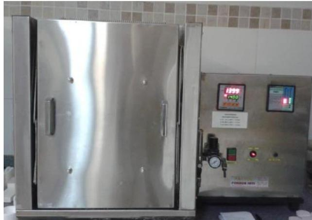
**FIG. 3.12 – Forno INTI utilizado na sinterização dos corpos cerâmicos.**
