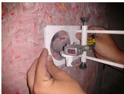
**FIG. 3.20 – Sensor laser utilizado para medida da indentação causada à plastilina após o ensaio balístico.**
