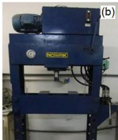
**FIG. 3.11 – (a) Molde metálico para conformação do pó cerâmico e (b) prensa hidráulica utilizada.**
