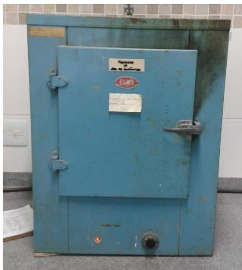
**FIG. 3.2 – Estufa da marca ELKA utilizada na secagem das fibras.**
