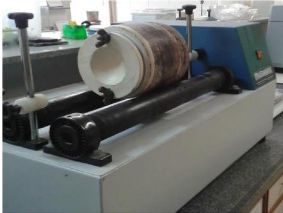
**FIG. 3.9 – Moinho de bolas da marca MARCONI utilizado no processamento dos pós cerâmicos.**
