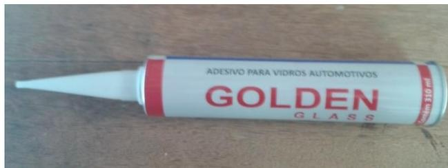
FIG. 3.14 – Adesivo de base poliuretano utilizado na colagem dos componentes do SBM.
