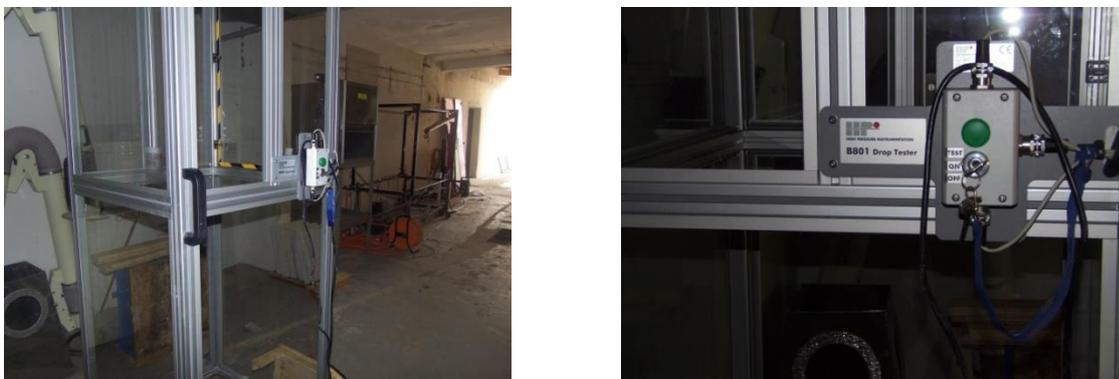
**FIG. 3.16 – Equipamento de queda de peso utilizado para verificar se a plastilina se encontra com densidade adequada antes do ensaio balístico (a) cabine e (b) sistema de acionamento.**
