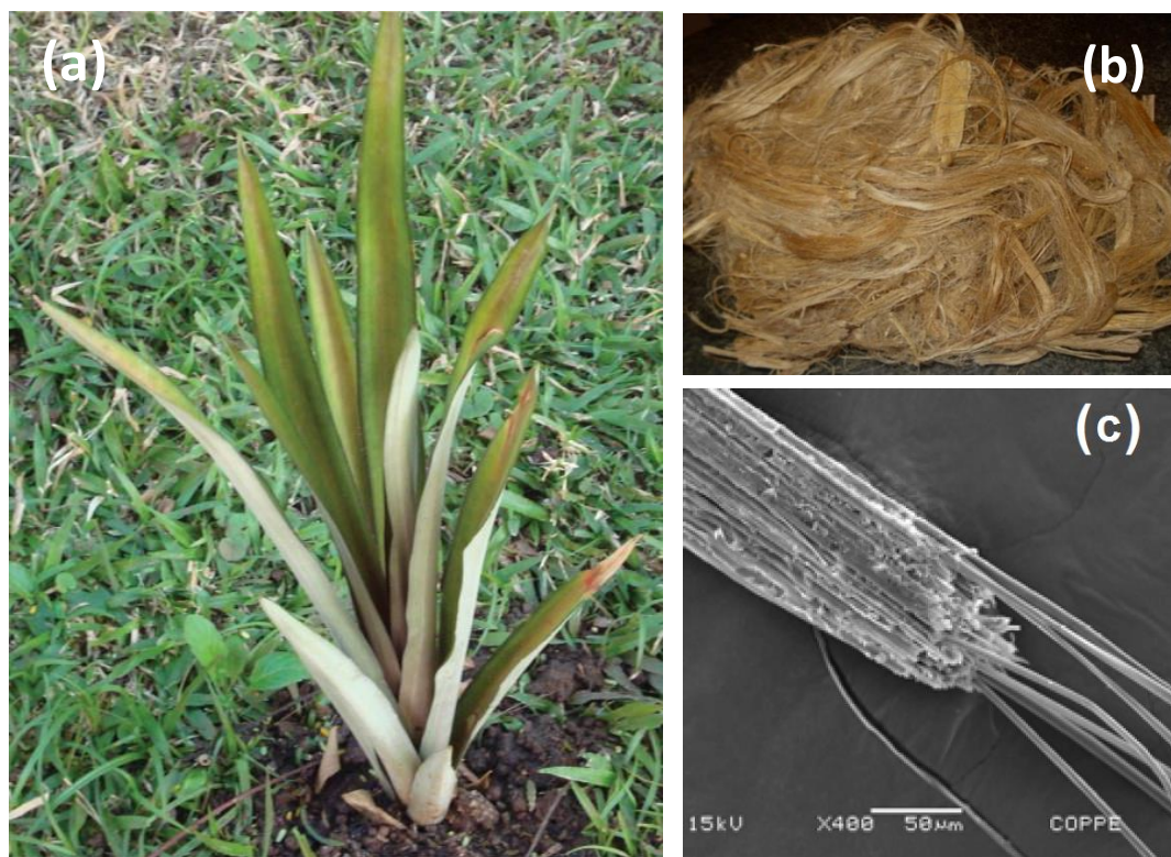
FIG. 2.12 Curauá: (a) Planata Ananas erectifolius ; (b) fibras prontas para uso; (c) fibra individual com suas microfibrilas, após fratura em tração.
