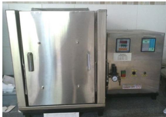
FIG. 3.6 Forno INTI FE 1700, utilizado na sinterização das pastilhas cerâmicas.
