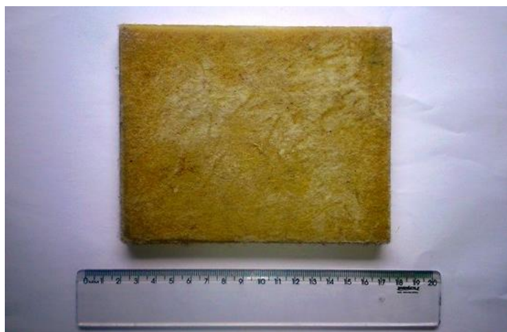
FIG. 3.8 Placa de compósito epóxi-curauá produzida por prensagem uniaxial a frio.
