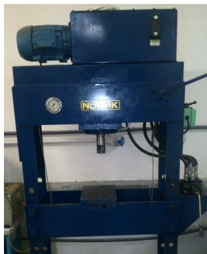
FIG. 3.5 Prensa hidráulica semiautomática Nowak, com capacidade para 30 toneladas.
