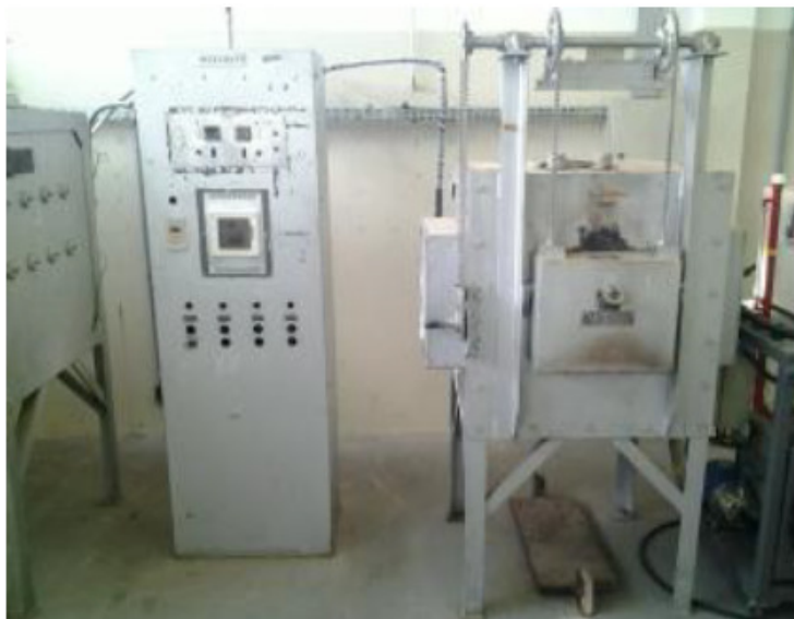
FIG. 3.5 Forno Mufla utilizado nas etapas iniciais de aquecimento para o forjamento a quente e nas etapas finais de tratamentos de solubilização prévios ao forjamento a frio.
