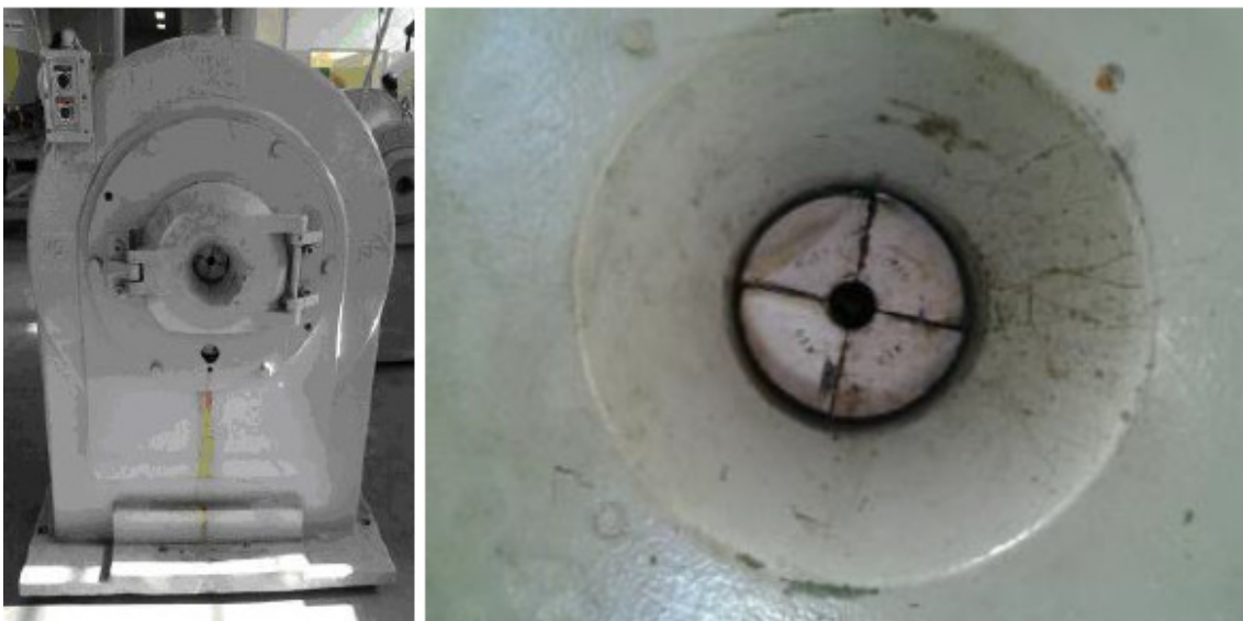
FIG. 3.3 Forja de 4 martelos (F4M) com o detalhe dos 4 martelos.
