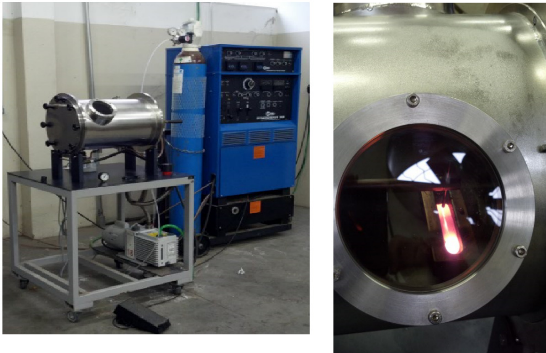
FIG. 3.2 Forno de Fusão a Arco Elétrico com detalhe do lingote fundido ao rubro no interior da câmara de fusão.
