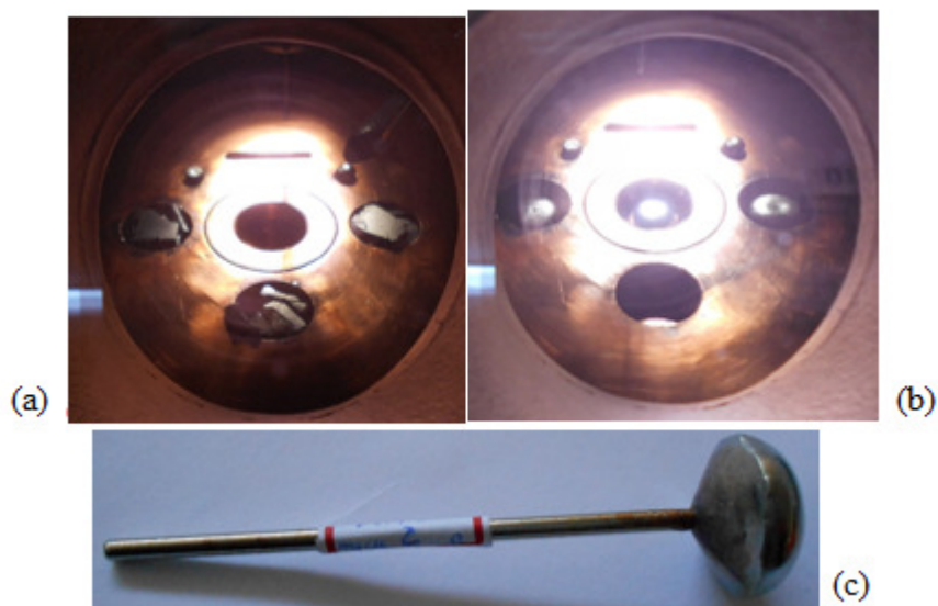
FIG. 3.8 Do carregamento a fusão / fundição por sucção a vácuo para obtenção do arame de 3,0 mm a partir da liga refundida no Forno VAR da UPT da FIG. 3.7.
