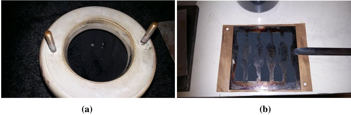
FIG. 3.3 Misturas: (a) NC6 no jarro após moagem e (b) NC5 no molde para ensaio de tração
