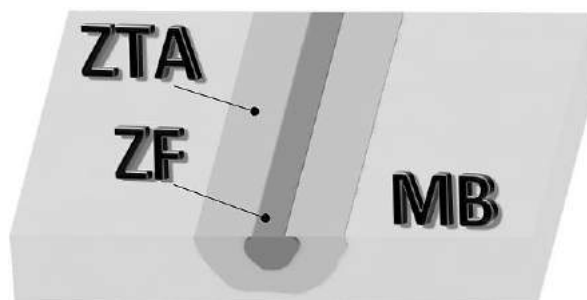
Figura 2.14 – Regiões típicas em uma solda por fusão.
