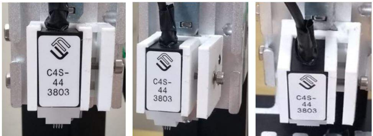
Figura 4.2 – Fixação da sonda no sistema de posicionamento.
