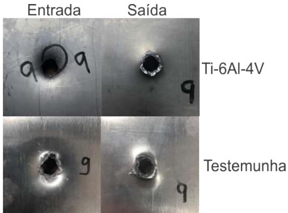
Figura 4.2.30 – Imagens da superfície de entrada e saída do projétil, para a perfuração número 9. Para o impacto na placa plana de Ti-6Al-4V de 2 mm de espessura e na placa testemunha.
