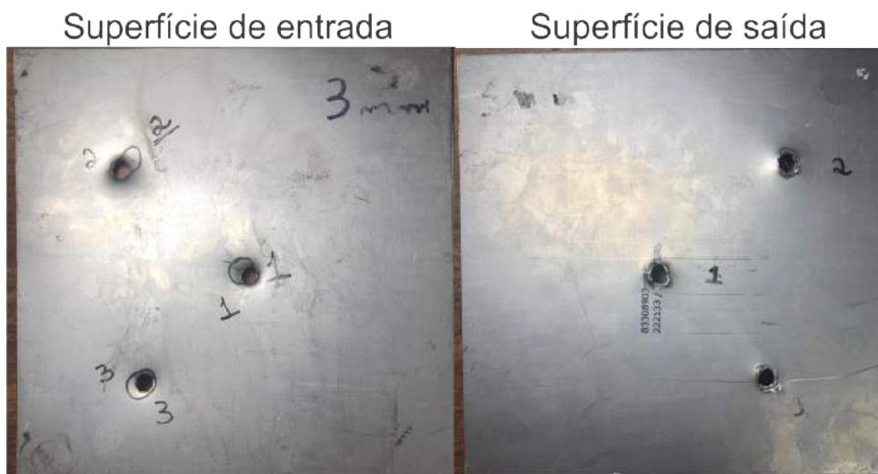
Figura 4.2.16 – Chapa plana de 3 mm de espessura, após o ensaio balístico;(a) face de entrada dos projéteis; (b) face de saída dos projéteis.
