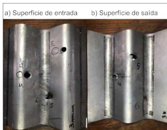
Figura 4.2.6 – Chapa poliondular de 3 mm de espessura após o ensaio balístico;(a) face de entrada dos projéteis; (b) face de saída dos projéteis.
