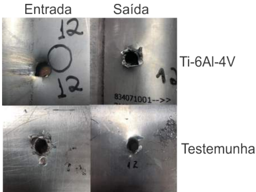
Figura 4.2.37 – Imagens da superfície de entrada e saída do projétil para a perfuração número 12. Para o impacto na região intermediária do perfil ondular da placa de 2mm de espessura e na placa testemunha.
