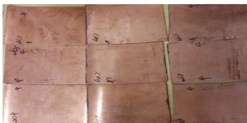
Figura 31 – Chapas laminadas à temperatura ambiente com redução de 20, 40 e 60%, dimensões aproximadas (250 x 120 mm).
