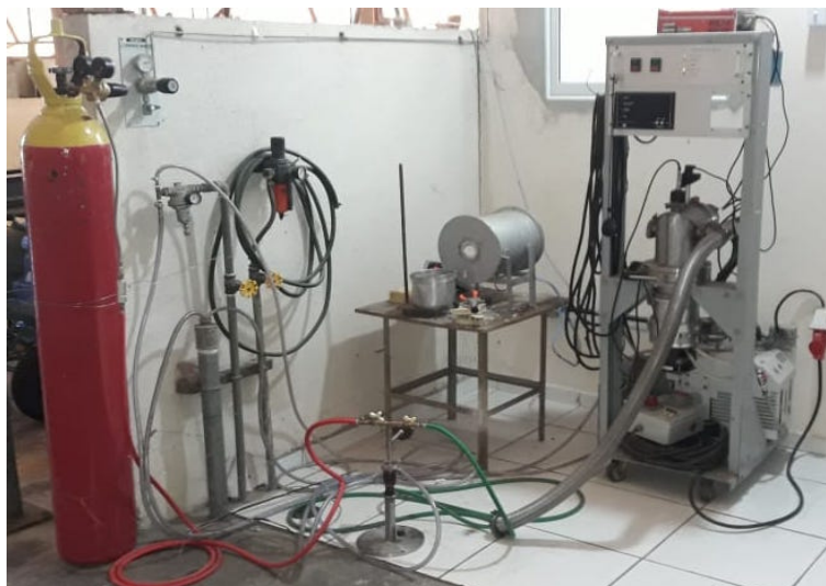
Figura 34 – Forno resistivo utilizado na redução dos compósitos.
