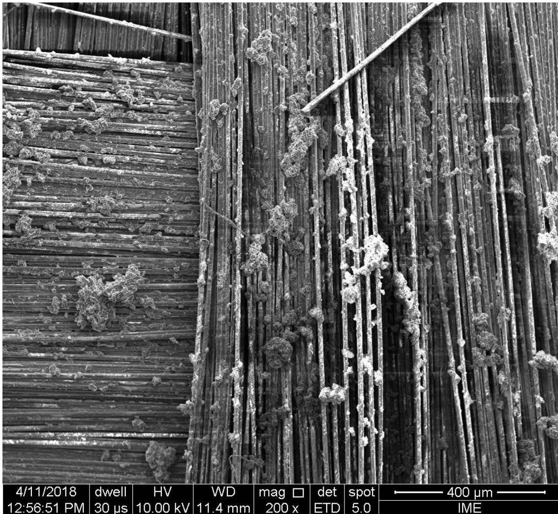
FIG 4.12: Imagem do MEV da amostra A07 mostrando a distribuição de STF em fibra de aramida.
