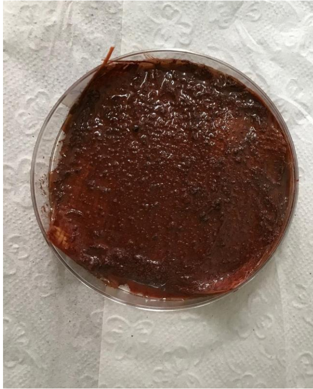
FIG 3.3 Fluido não newtoniano impregnado na aramida.
