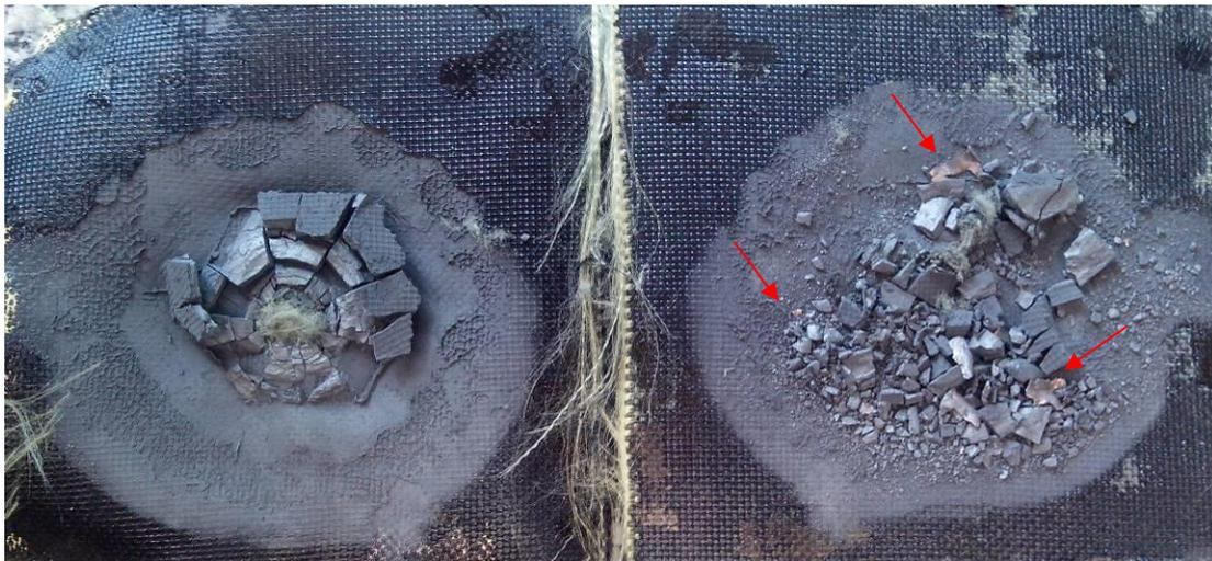
FIG. 4.27 Painel balístico do grupo III aberto após o ensaio. Pedacos do projétil estão indicados.
