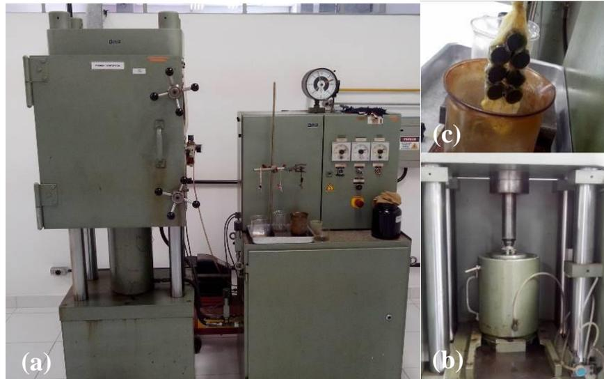
FIG. 3.4 Prensagem isostática: (a) Unidade de prensagem Paul Weber; (b) Vista da câmara hidrostática e (c) amostras logo depois de prensadas.
