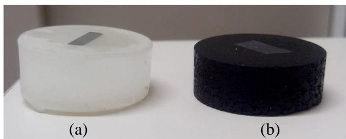
FIG. 3.12 Amostras embutidas: (a) Resina acrílica e (b) Baquelite.
