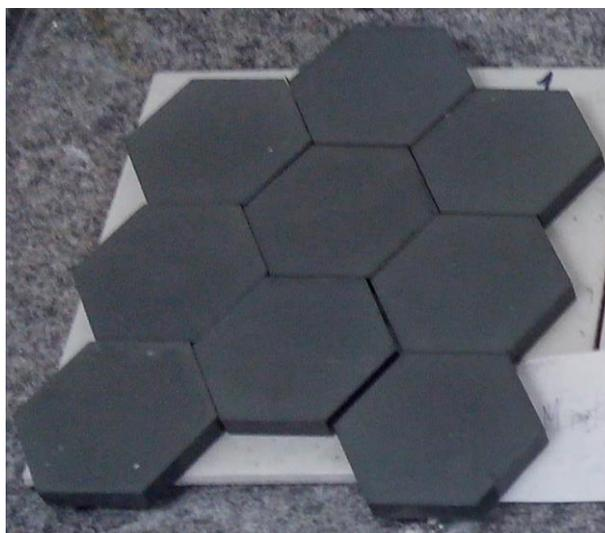
FIG. 4.8 Corpos verdes hexagonais com 5% de aditivos produzidos por prensagem uniaxial.
