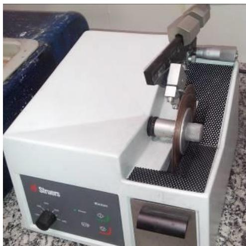
FIG. 3.11 Operação de corte realizada na Struers Minitom.
