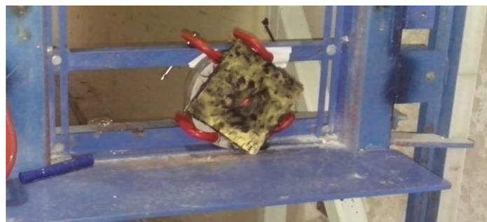
FIG. 3.21 Fixação de painel para o ensaio de velocidade residual.
