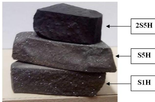
FIG. 4.22 Superfície de fratura das placas S1H, S5H e 2S5H.
