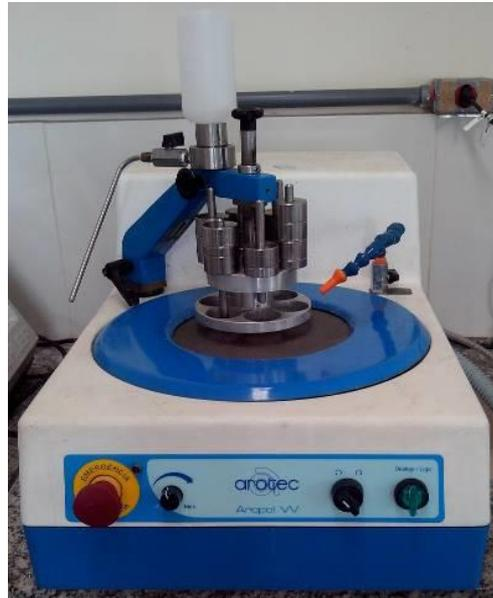
FIG. 3.13 Operação de desbaste realizada na Arotec VV.
