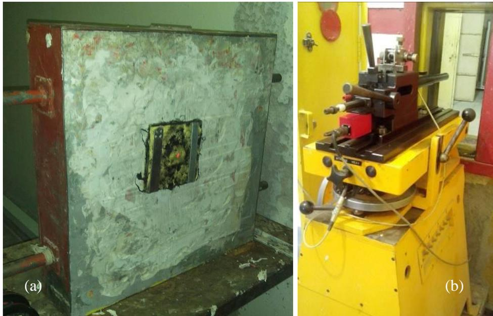
FIG. 3.19 (a) Painel balístico fixado junto ao bloco de plastilina e (b) Provette 7,62 mm com mira a laser.
