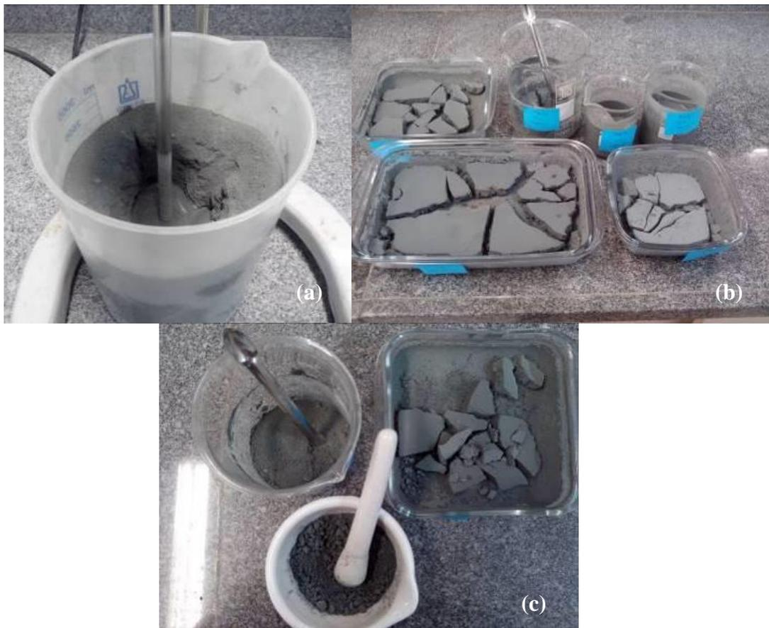
FIG. 3.2 Fotografia dos procedimentos de mistura (a), pós aglomerados após secagem em estufa (b) e quebra de agregados com gral e pistilo (c)
