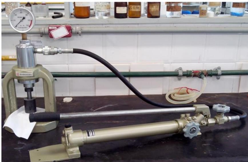
FIG. 3.3 Prensa de bancada Shimadzu e matriz de compactação uniaxial.
