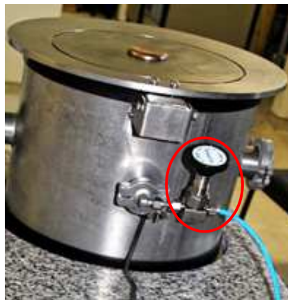
FIG 4.29 Fotografia mostrando a localização da válvula de admissão de gás de trabalho.
