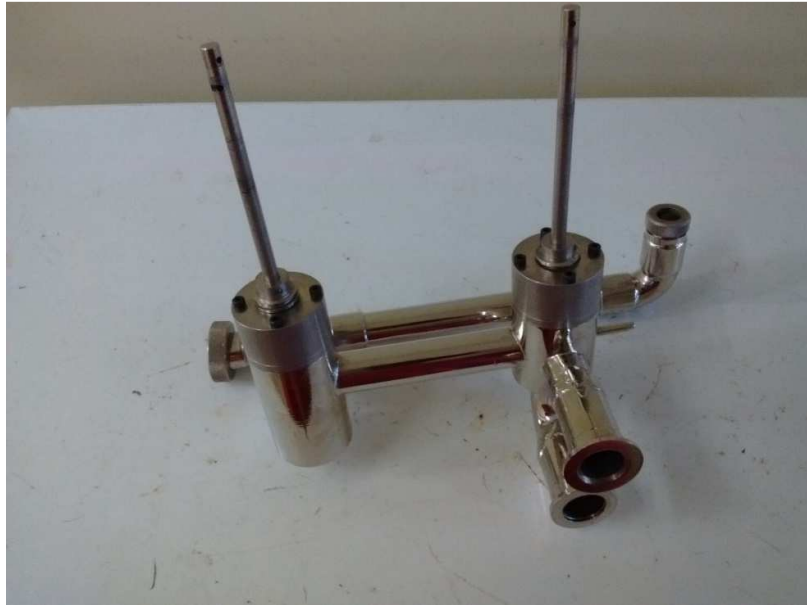
FIG 4.16 Conjunto de válvulas utilizado para controle das etapas de bombeamento do sistema de vácuo.
