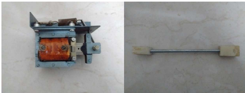
FIG 4.20 (a) fotografia do eletroímã utilizado para a construção do obturador; (b) haste rosqueada para conexão entre feedthrough de movimento e o eletroímã.
