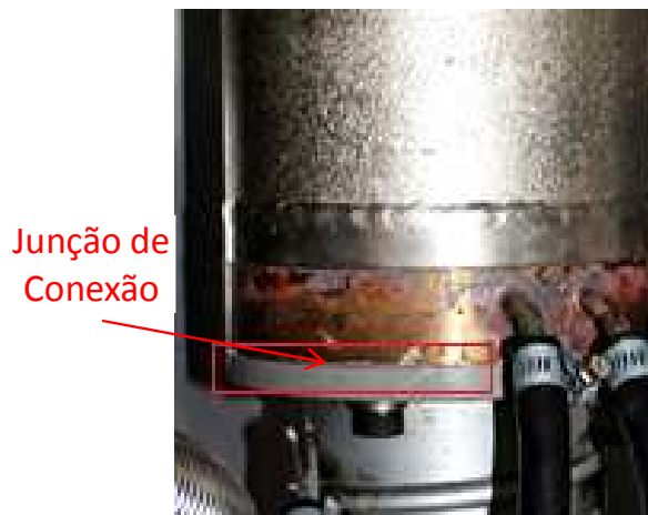
FIG 6.4 Fotografia mostrando a junção entre a bomba de difusão e o recipiente criogênico.
