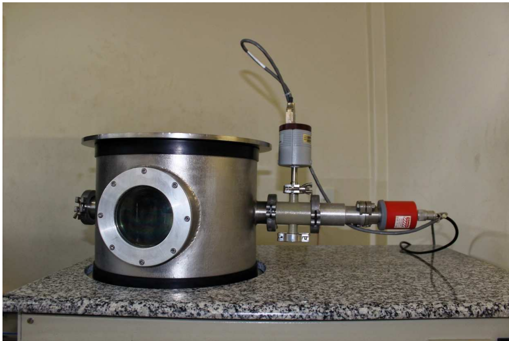
FIG 4.25 Fotografia mostra a câmara já fixada em sua base com os medidores instalados para aferição da pressão em seu interior.
