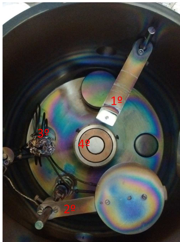
FIG 4.22 Fotografia do Interior da campânula. (1º) haste de fixação do porta-substrato; (2º) obturador para proteção dos substratos; (3º) medidor de taxa de evaporação e (4º) catodo.
