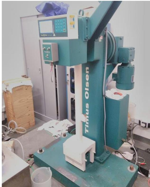
**FIG. 3. 13** Fotografia da máquina de impacto Tinus Olsen, modelo IT542M.
