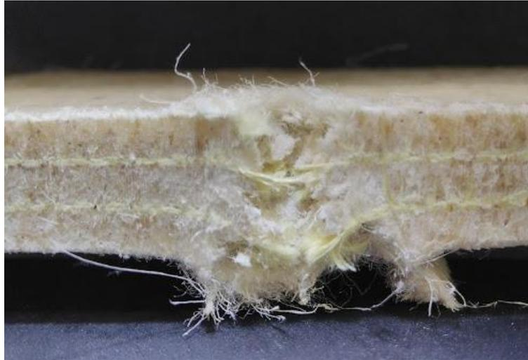
**FIG. 4. 39** Fotografia do compósito “como recebido” após ensaio balístico.
