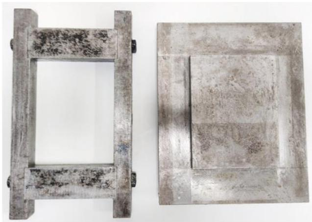
**FIG. 3. 4** Matriz metálica utilizada na prensagem dos compósitos.
