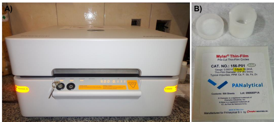
FIG. 21 Equipamento de espectroscopia de fluorescência de raios-X do Laboratório de Biomateriais (A), porta amostras montado para a análise e caixa da embalagem dos filmes plásticos onde constam as possíveis contaminações (B).
