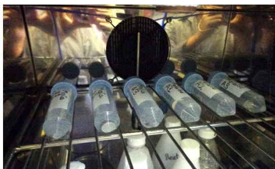
FIG. 26 Amostras do ensaio de corrosão por perda de massa, imersas em NaCl, dentro da estufa a 36 °C.
