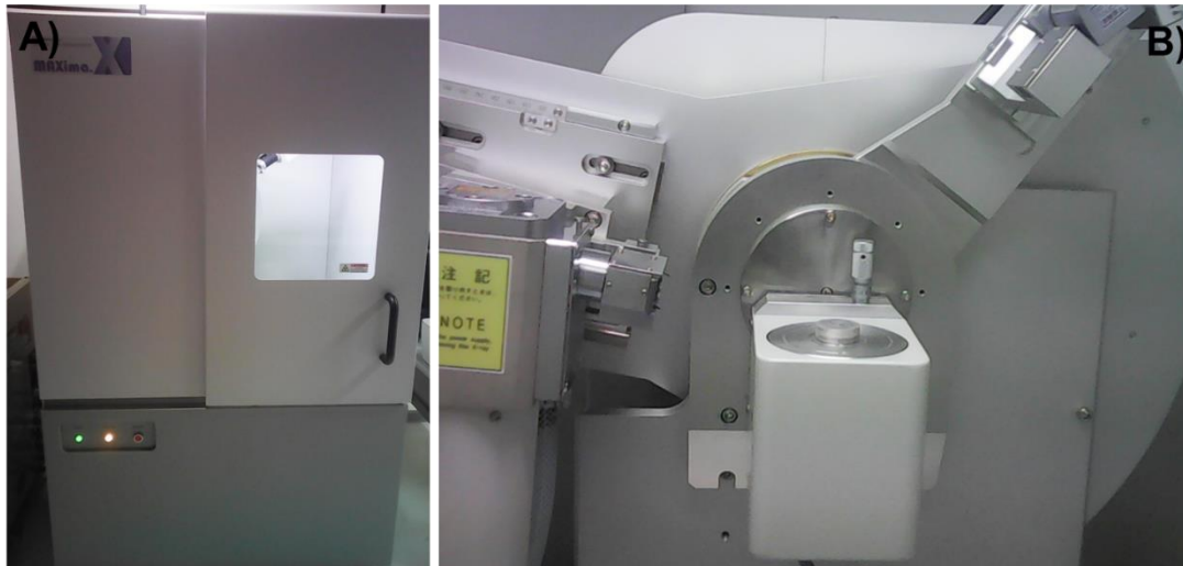
FIG. 22 Equipamento de difração de raios-X do LaCEM, na PUCPR, (A) e amostra sendo analisada (B).
