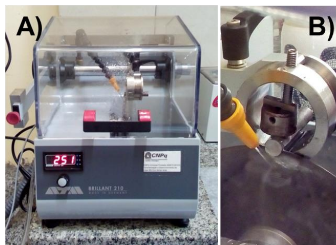
FIG. 19 Cortadeira do Laboratório de Biomateriais (A) durante o processo de corte de uma amostra (B).
