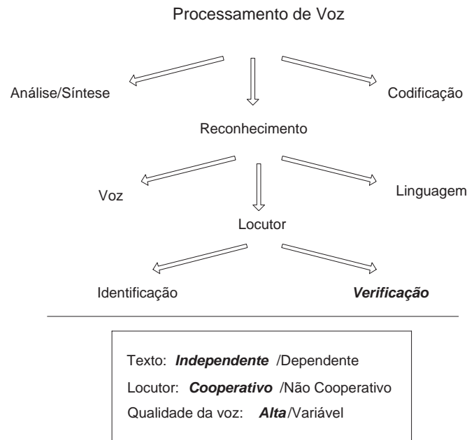
FIG. 2.1: Algumas áreas do processamento de voz, com destaque para o reconhecimento de locutor. As palavras em negrito indicam a abrangência desta dissertação.
