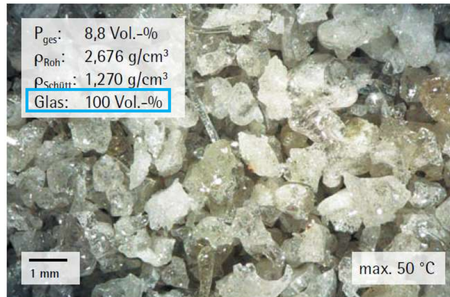
Bild 78: Wirkung verschiedener Granulationswassertemperaturen auf die Hüttensandeigenschaften bei gleicher chemischer Zusammensetzung
