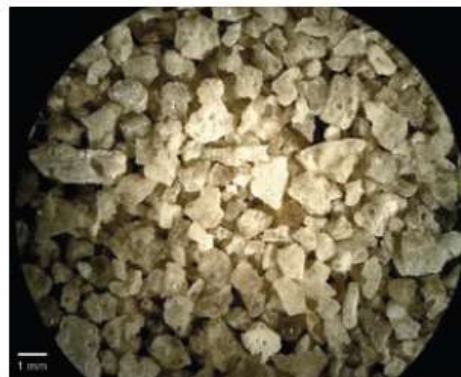
Bild 51: Typischer Hüttensand ( \rho_{Roh} = 2,490 \text{ g/cm}^3 )
