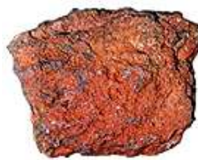
Hematita vermelha \equiv \text{Fe}_2\text{O}_3
