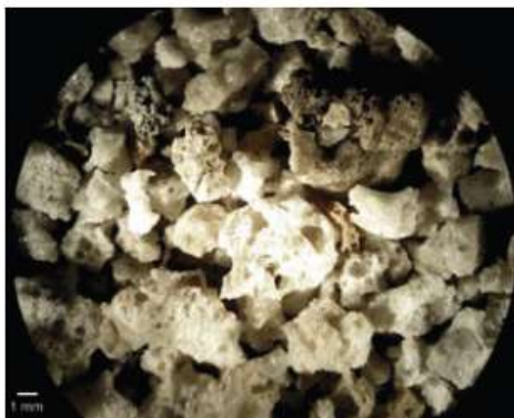
Bild 49: Extrem poriger Hüttensand ( \rho_{Roh} = 2,021 \text{ g/cm}^3 )
