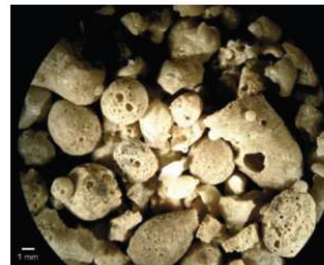
Bild 53: Hüttensandpellets, 1998 ( \rho_{Roh} = 2,028 \text{ g/cm}^3 )
