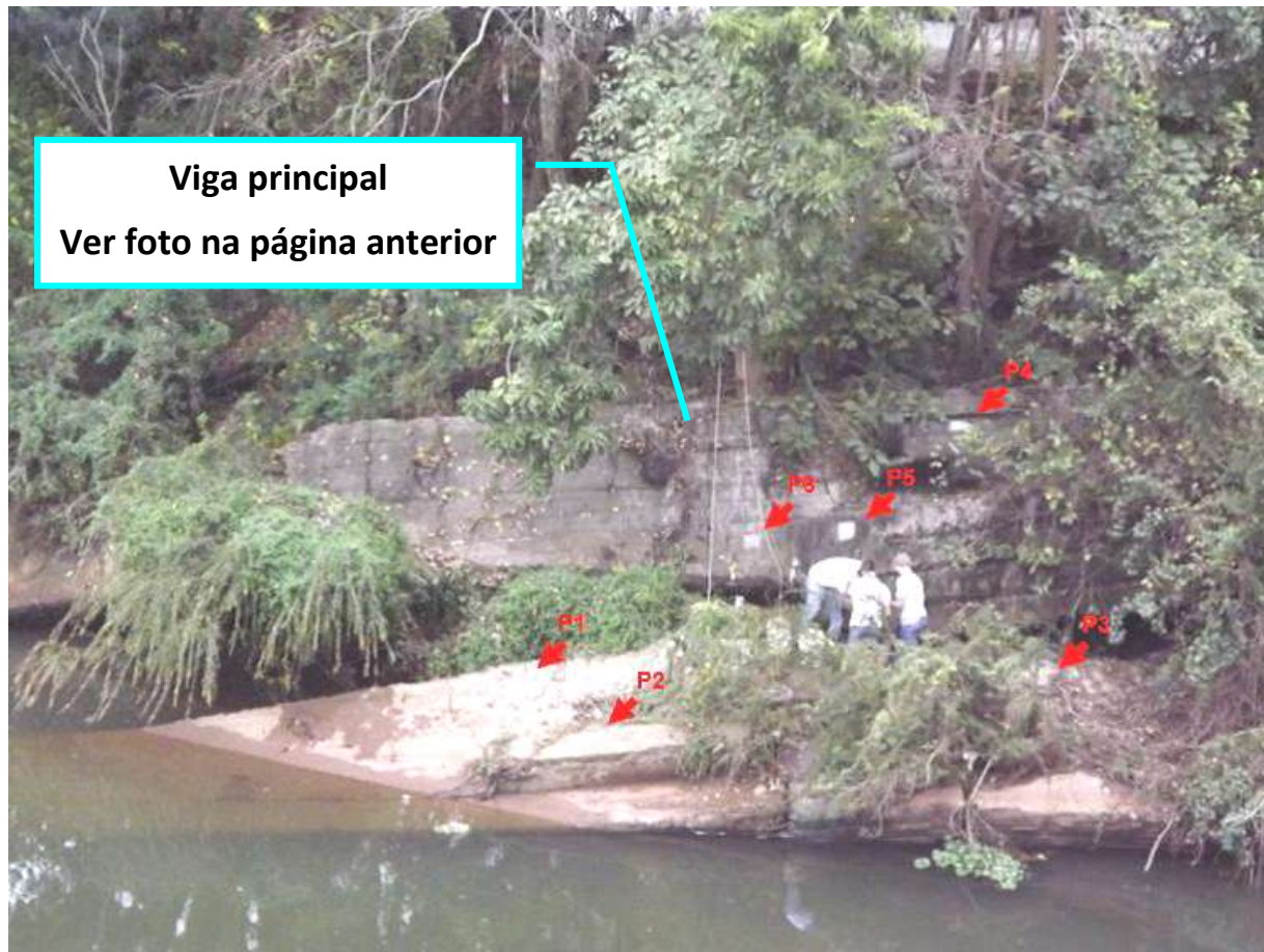
Esclerometria em vários pontos
