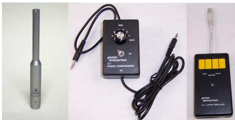
Figura 5.17: Microfone usado com o eletroglotógrafo para captação do sinal de voz, compensador de fase (C-1) e simulador de laringe (LS-1), respectivamente.
